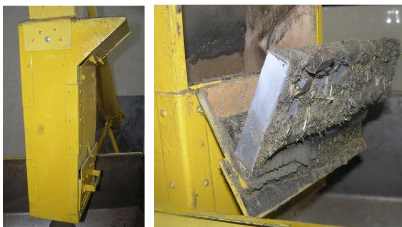
Рис. 1. Магнітний сепаратор (а) та результати його роботи (б)
