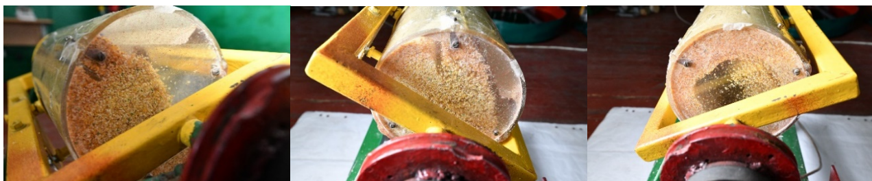
Рис. 1. Режими руху маси комбікорму в барабанному змішувачі: а – рух з обрушенням; б – циркуляційний рух; в – закритий режим руху
