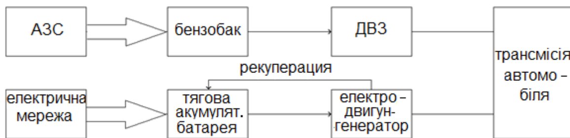
Рис. 2. Функціональна схема гібридного автомобіля з підзарядкою
