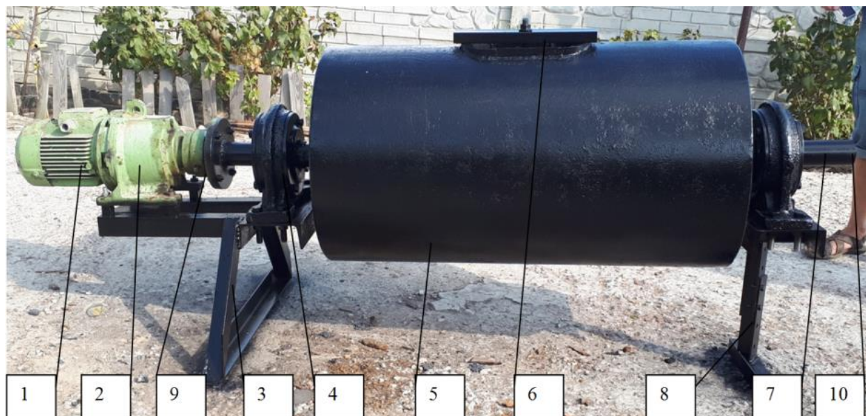
Рис. 1. Реактор барабанного типу: 1 – електродвигун; 2 – редуктор планетарний; 3 – рама; 4 – опора підшипникова; 5 – ємність; 6 – люк завантажувальний; 7 – вісь; 8 – стійка регульована; 9 – муфта з'єднувальна; 10 – штуцер із внутрішньою різьбою.
