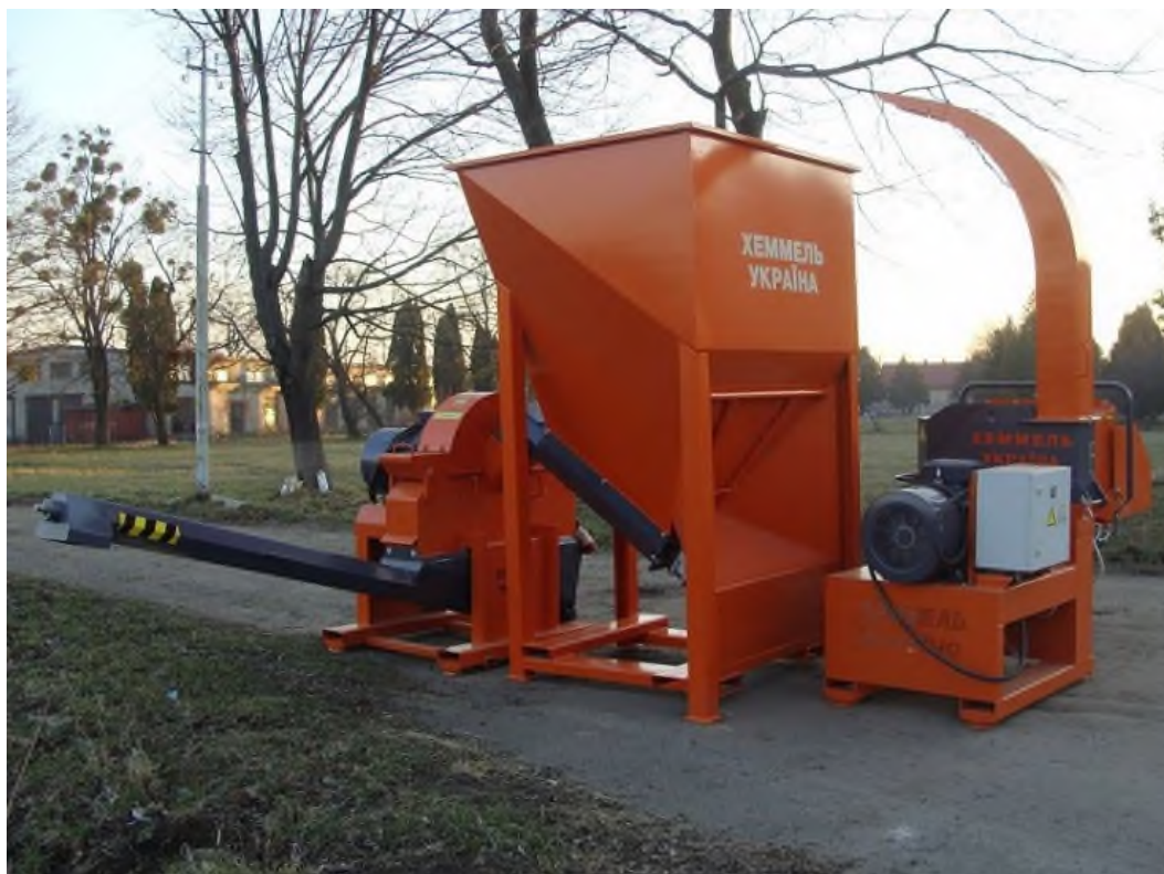
Рис. 2. Лінія подрібнення сухих шматкових відходів RK 847 [6].
