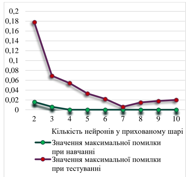
Рис. 3. Графік збіжності значень максимальної помилки розпізнавання дефектів ЦПГ при навчанні і тестуванні ШНМ.
