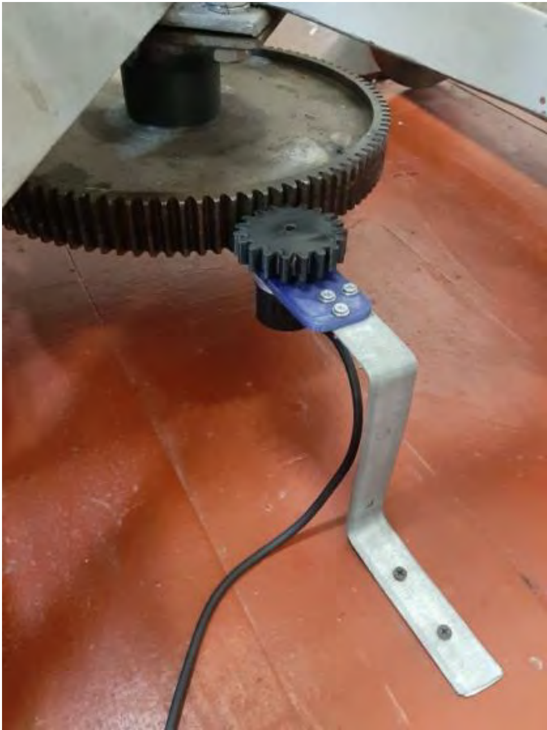
Рис. 4.9. Інкрементальний енкодер Megatron-Impulsgeber MOL40 6 3600 – BZ N
