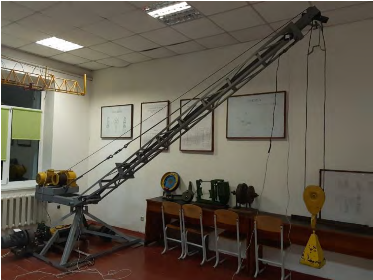
Рис. 4.4. Фізична модель механізму повороту стрілового крана
