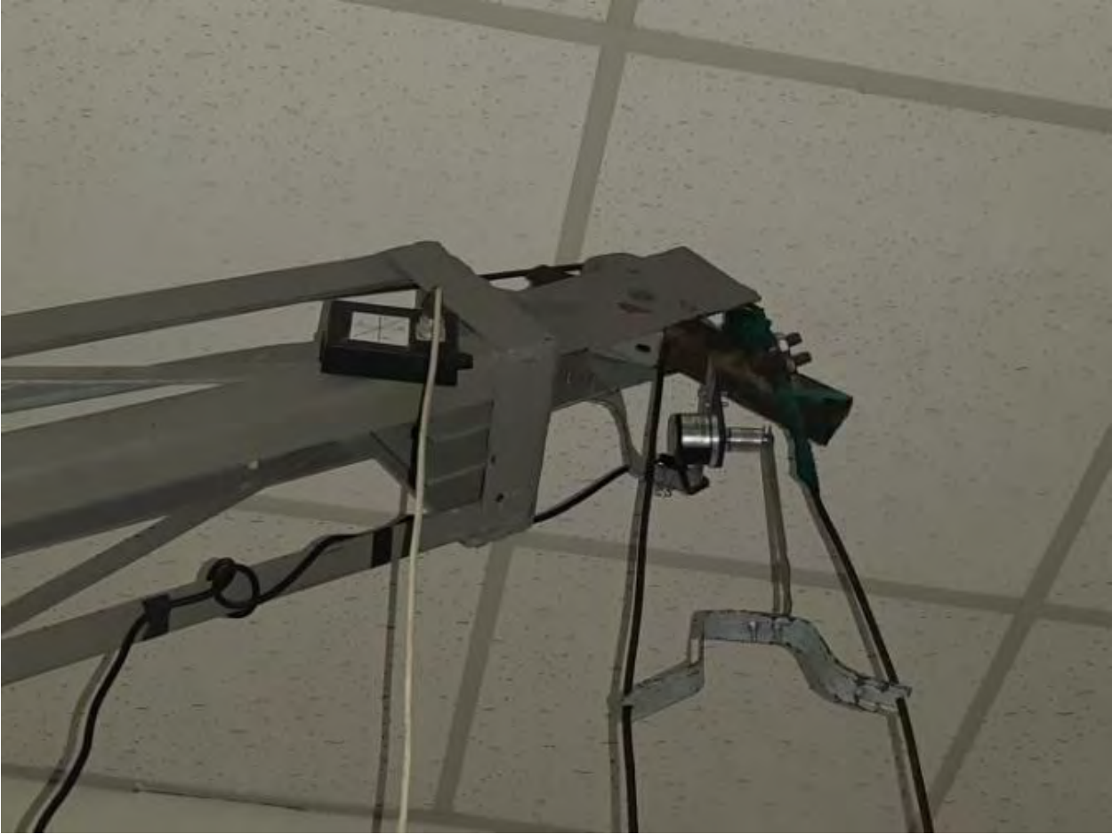
Рис. 4.7. Кутовий енкодер Megatron-Impulsgeber MOL40 6 3600 – BZ N та акселерометр MMA7260QT
