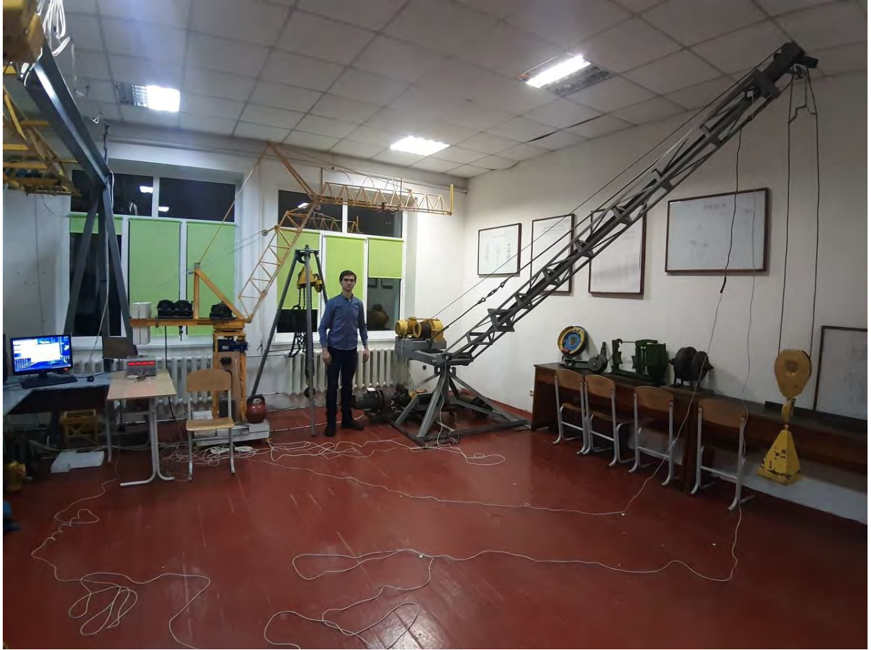
Рис. 4.6. Загальний вигляд фізичної моделі (експериментальної установки) для дослідження руху механізму повороту стрілового (баштового) крана з закріпленими датчиками
