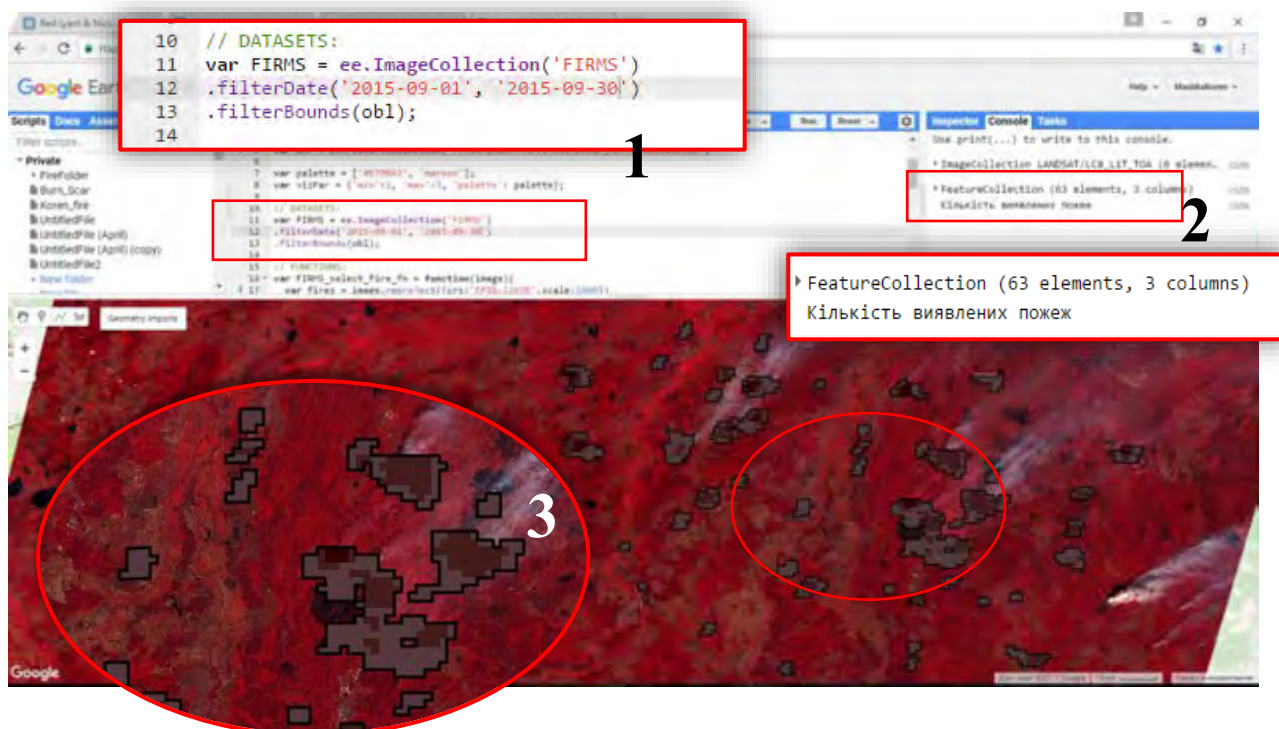
Рис. 4.5. Використання платформи GEE для дешифрування пожеж на території Рівненської області (вересень 2015 р.): 1 – вибір дати; 2 – кількість виявлених пожеж (63); 3 – орієнтовні контури пожеж
