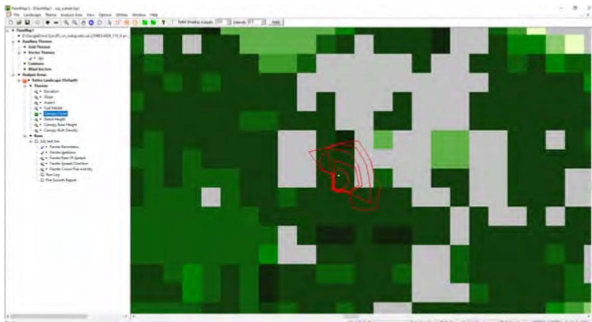
Рис. 6.6. Погодинні контури пожежі на фоні карти зімкнутості деревостанів, згенеровані алгоритмом FARSITE
