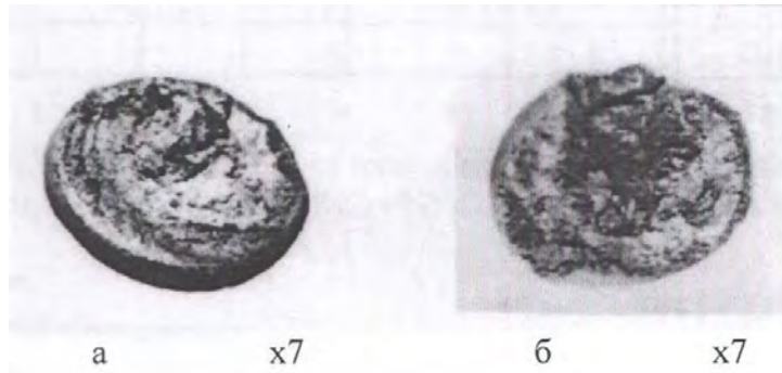
Рисунок 11.6 – Зовнішній вигляд контактів із матеріалу \text{CrM-0,2} електромагнітного пускача ПМЛ-1100В після 1 \times 10^5 комутацій ( I = 6,3 \text{ A} ):
