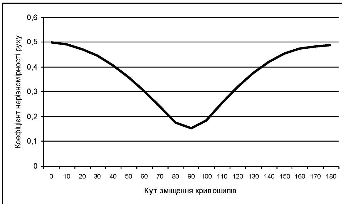
Рис. 6.20. Графік зміни коефіцієнта нерівномірності руху в залежності від кута зміщення кривошипів
