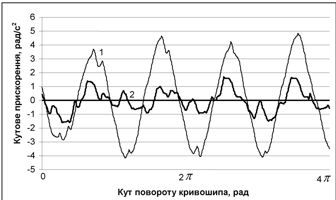
Рис. 9.22. Графіки зміни кутового прискорення привідного вала установки в холостому режимі з одним формувальним візком – 1 та з двома візками – 2
