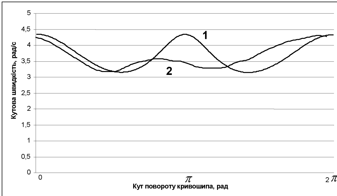
Рис. 9.33. Порівняння теоретичних (1) та експериментальних (2) результатів визначення кутової швидкості привідного вала установки з одним формувальним візком в робочому режимі роботи
