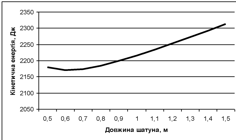
Рис. 4.2. Графік зміни середнього значення кінетичної енергії T_{cp} в залежності від довжини шатуна
