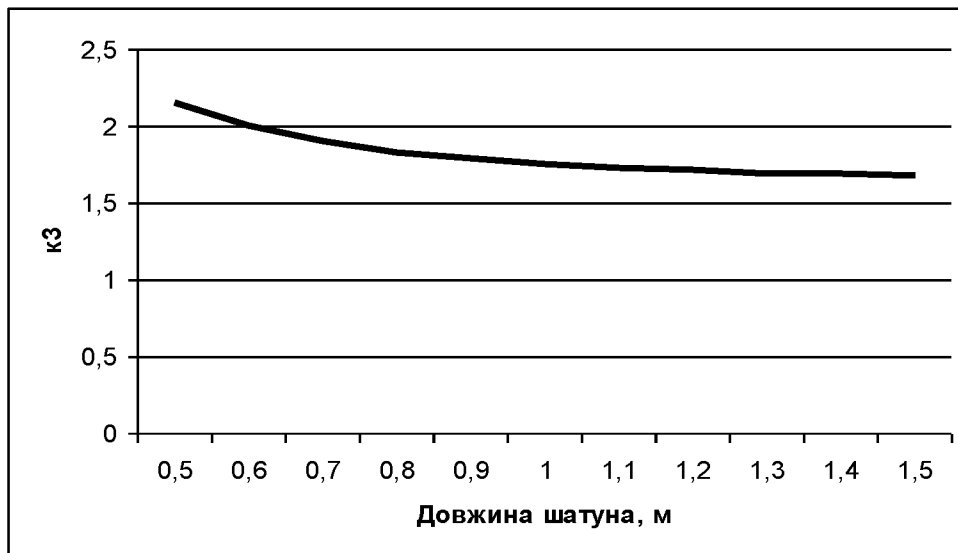
Рис. 4.5. Графік зміни відносного показника k_3 в залежності від довжини шатуна
