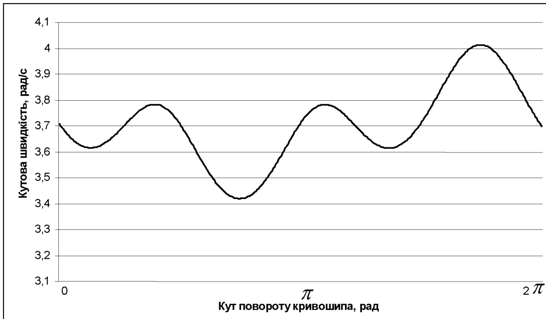
Рис. 9.19. Графік зміни кутової швидкості кривошипа фізичної моделі установки від кута його повороту
