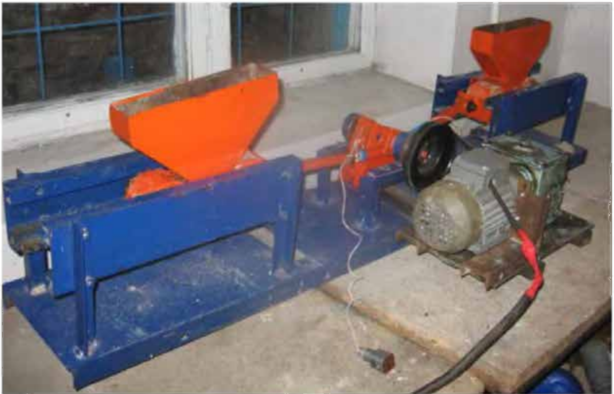
Рис. 9.2. Фізична модель роликової формувальної установки з рекупераційним приводом
