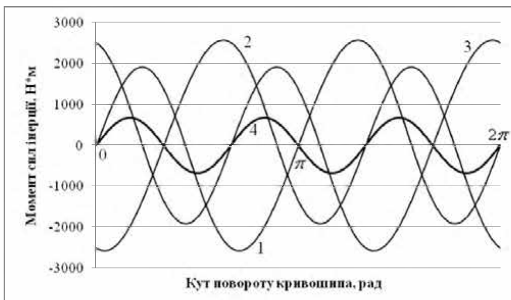
Рис. 3.17. Графіки зміни моментів сил інерції установки: 1, 2, 3 – моменти від сил інерції першого, другого та третього візків відповідно; 4 – сумарний момент сил інерції
