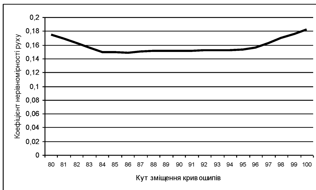
Рис. 6.23. Графік зміни коефіцієнта нерівномірності руху в залежності від кута зміщення кривошипів
