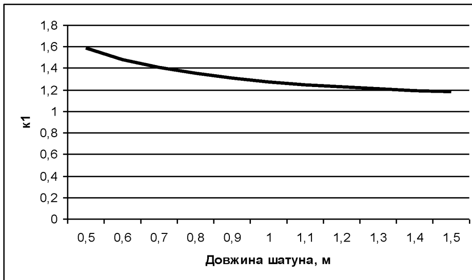
Рис. 4.3. Графік зміни відносного показника k_1 в залежності від довжини шатуна
