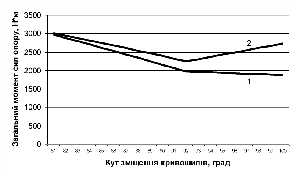
Рис. 3.14. Графіки зміни відхилень \Delta M_{з.оп.макс} – 1 та \Delta M_{з.оп.} – 2 в залежності від кута зміщення кривошипів в межах від від \Delta\varphi = 81^{\circ} до \Delta\varphi = 100^{\circ}
