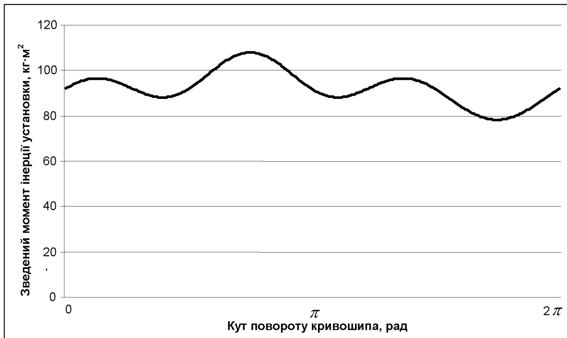
Рис. 6.12. Графік зміни зведеного моменту інерції установки від кута повороту кривошипа
