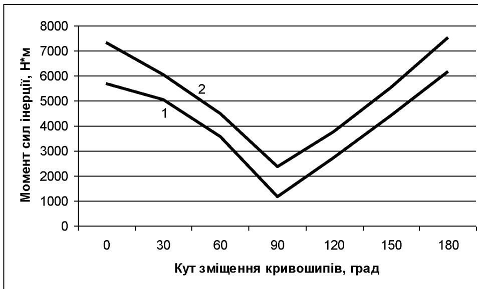
Рис. 3.9. Графіки зміни відхилень зведеного моменту від сил інерції \Delta M_{max} – 1 та \Delta M_i – 2 в залежності від кута зміщення кривошипів
