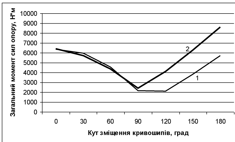
Рис. 3.11. Графіки зміни відхилень зведеного моменту сил опору \Delta M_{з.оп.max} – 1 та \Delta M_{з.оп.} – 2 в залежності від кута зміщення кривошипів
