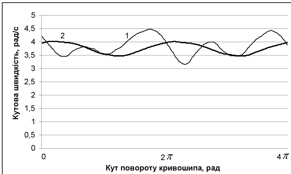
Рис. 9.23. Графіки зміни кутової швидкості привідного вала установки в робочому режимі з одним формувальним візком – 1 та з двома візками – 2
