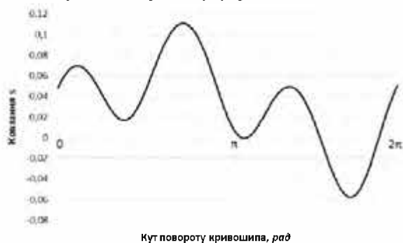
Рис. 10.24. Графіки зміни ковзання (а) та втрат потужності у колі ротора електродвигуна (б) установки з енергетично врівноваженим приводом
