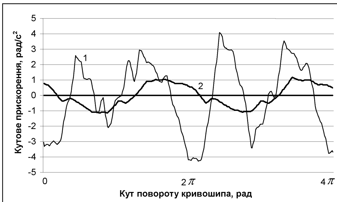
Рис. 9.24. Графіки зміни кутового прискорення привідного вала установки в робочому режимі з одним формувальним візком – 1 та з двома візками – 2
