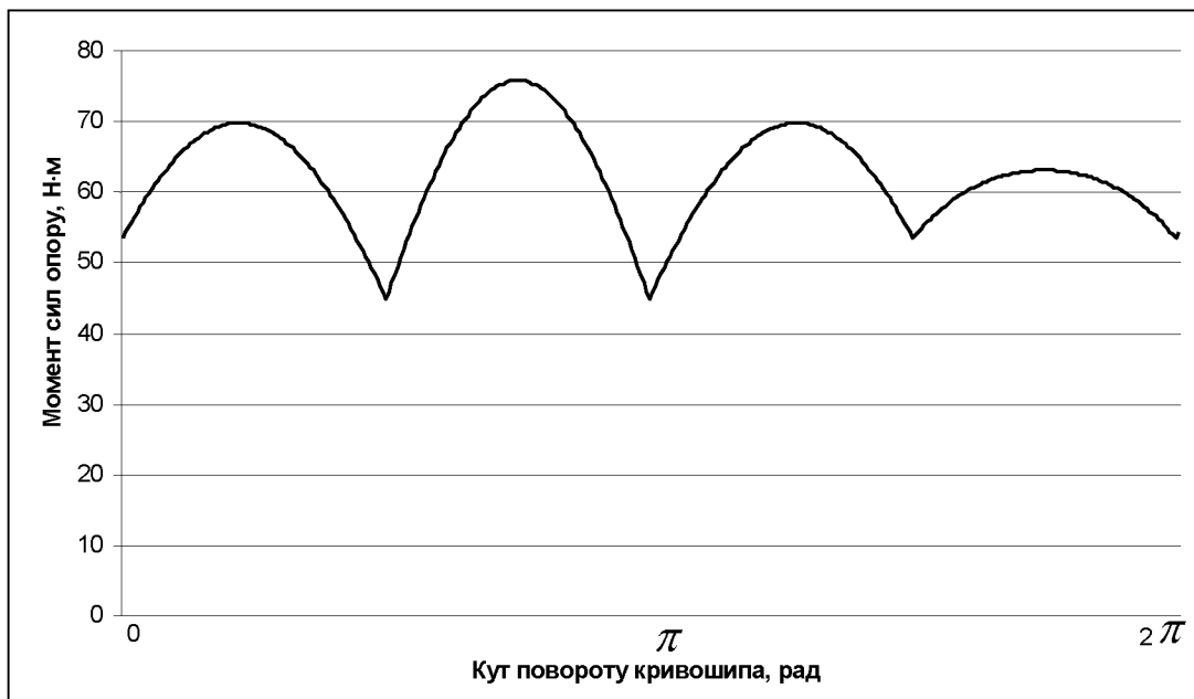
Рис. 9.17. Графік зміни моменту сил опору на переміщення формувальних візків від кута повороту кривошипа
