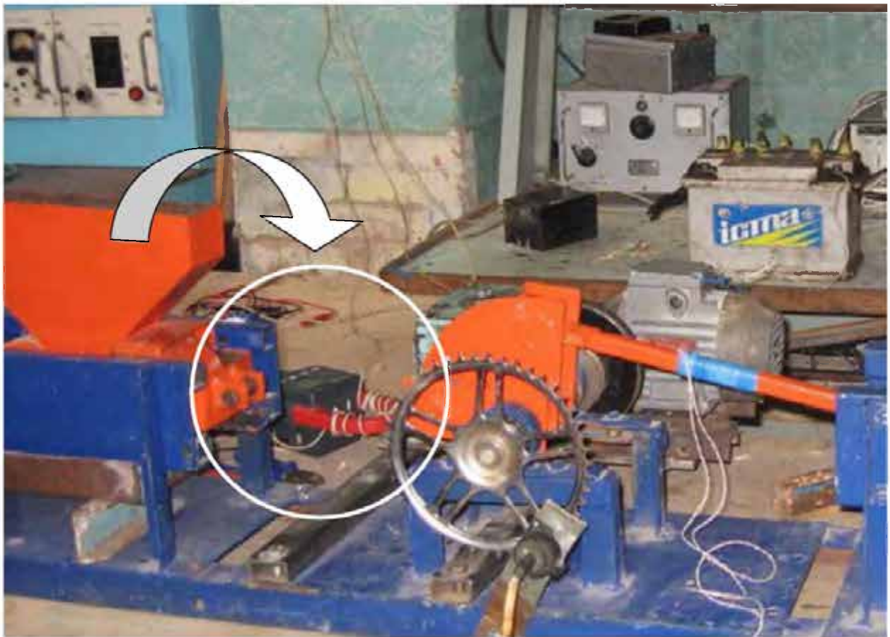
Рис. 9.11. Розташування кліщів РК 435 для вимірювання потужності двигуна
