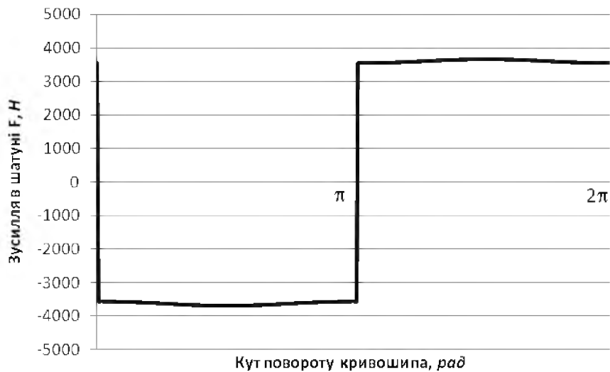
Рис. 7.4. Графік зміни зусилля в шатуні F в залежності від кута повороту кривошипа
