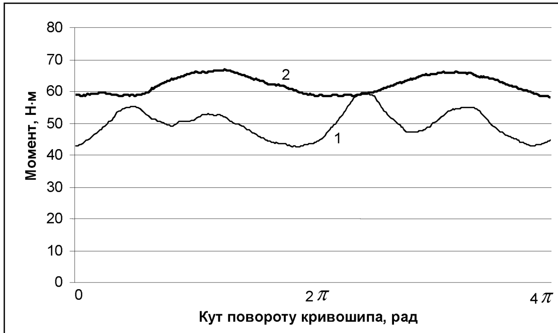
Рис. 9.30. Графіки зміни крутного моменту на привідному валу установки в робочому режимі з одним формувальним візком – 1 та з двома візками – 2
