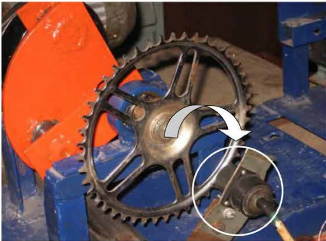
Рис. 9.6. Розташування датчика вимірювання кутової швидкості обертання приводного вала ДЧВ-1
