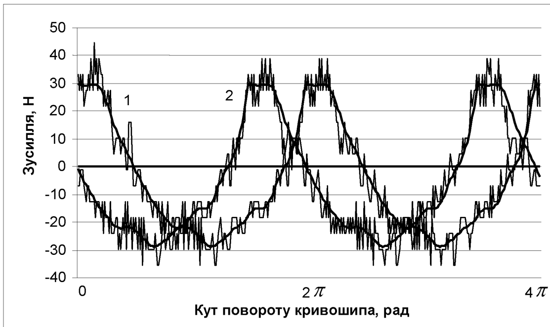
Рис. 9.26. Графіки зміни зусилля в шатунах в холостому режимі роботи
