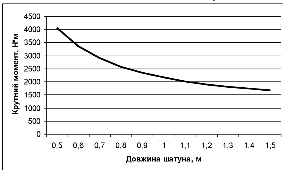
Рис. 4.6. Графік зміни максимального значення загального моменту сил опору M_{заг. max}^* в залежності від довжини шатуна
