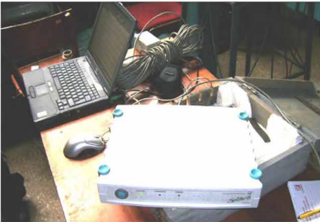
Рис. 9.12. Підсилювач-перетворювач SPIDER 8-FO5254 та персональний комп'ютер HP6100 з програмним продуктом Catman Express 4.5
