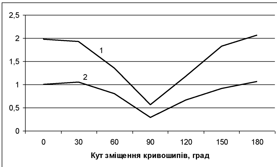
Рис. 3.3. Графіки зміни відносних коефіцієнтів \varepsilon_1 та \varepsilon_2 в залежності від кута зміщення кривошипів
