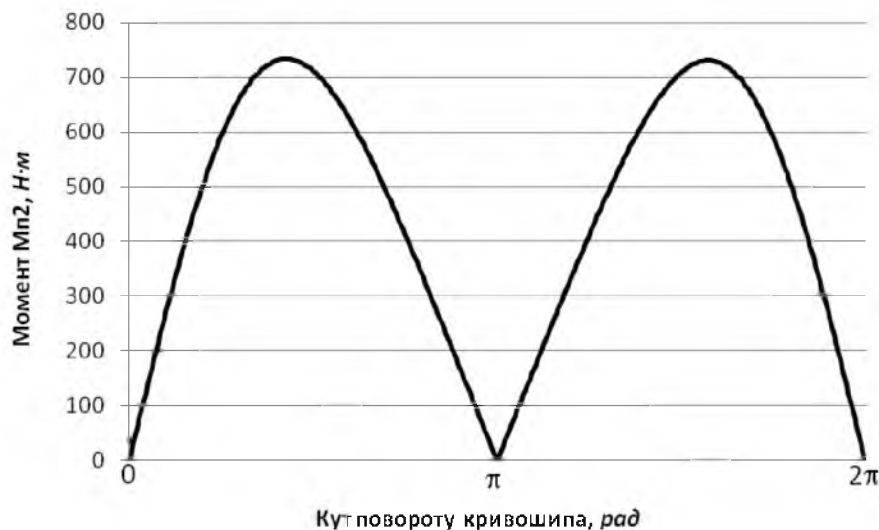
Рис. 7.5. Графік зміни моменту сил опору M_{п2} в залежності від кута повороту кривошипа
