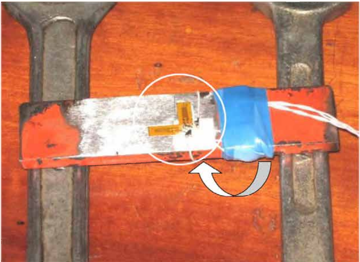
Рис. 9.5. Розташування тензодатчиків на пластині
