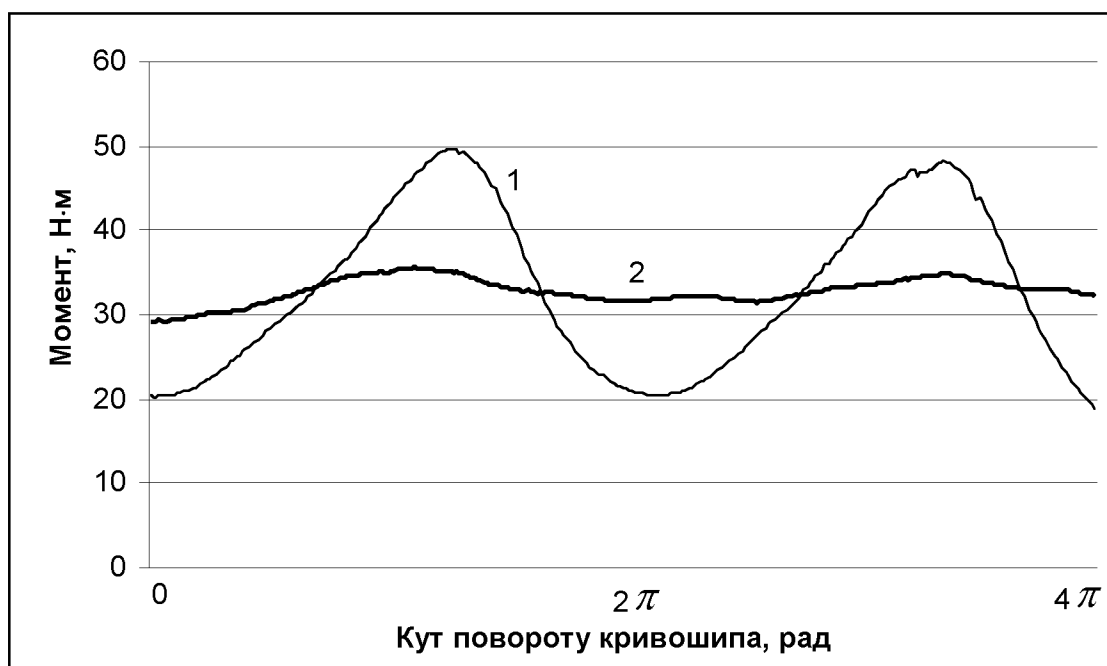
Рис. 9.29. Графіки зміни крутного моменту на привідному валу установки в холостому режимі роботи з одним візком – 1 та з двома візками – 2
