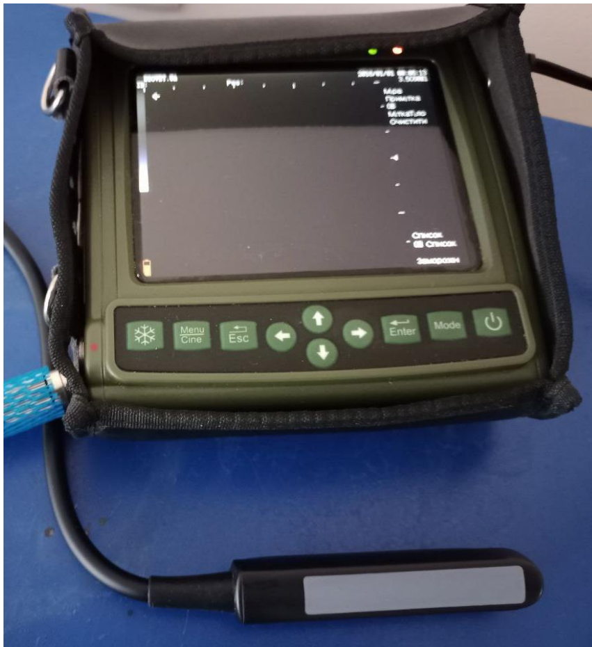
Рис. 7.3. Універсальний ультразвуковий сканер для ветеринарії Kaixin V1
