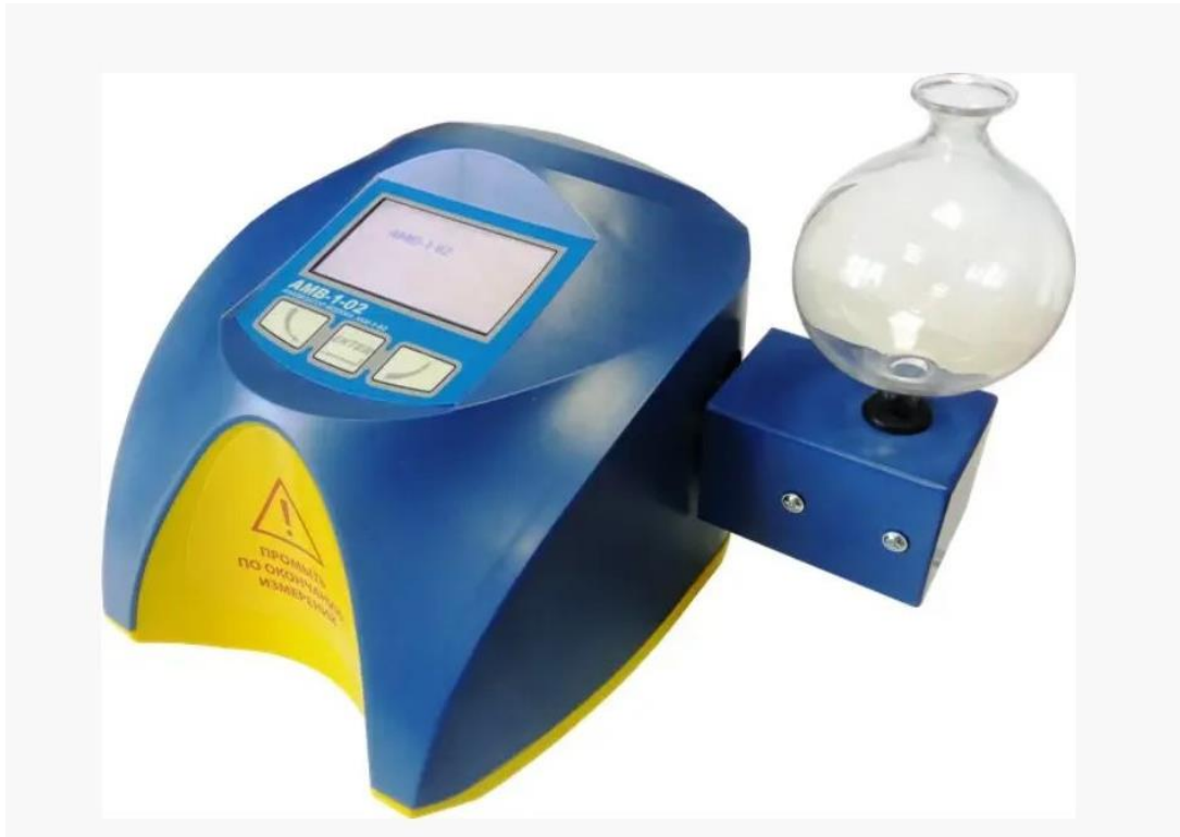
Рис. 7.23. Аналізатор соматичних клітин АМВ 1-02
