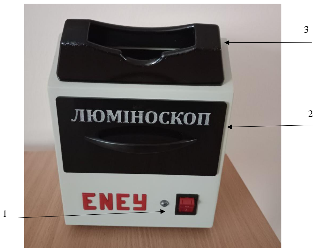
Рис. 7.21 Люміноскоп «ЕНЕЙ»: 1 – тумблер; 2 – оглядова камера; 3 – біоокуляр
