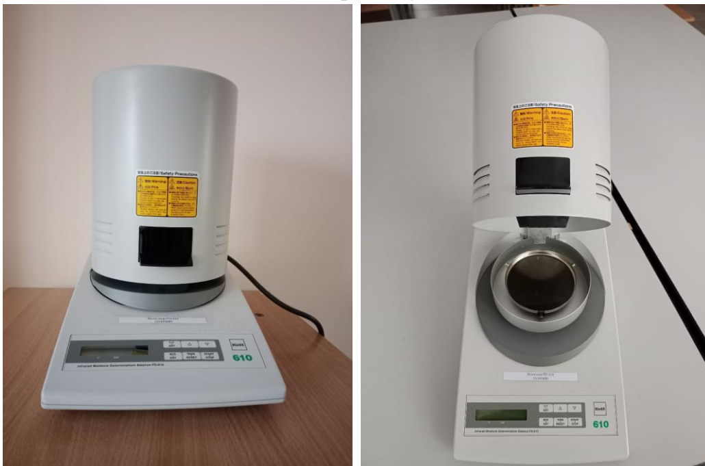
Рис.7.16. Прилад для вимірювання вмісту вологи Kett 610
