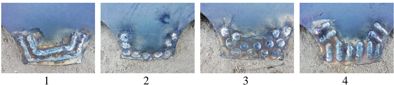
Рис. 10. Варіанти нанесення зносостійкого покриття на дискові робочі органи
