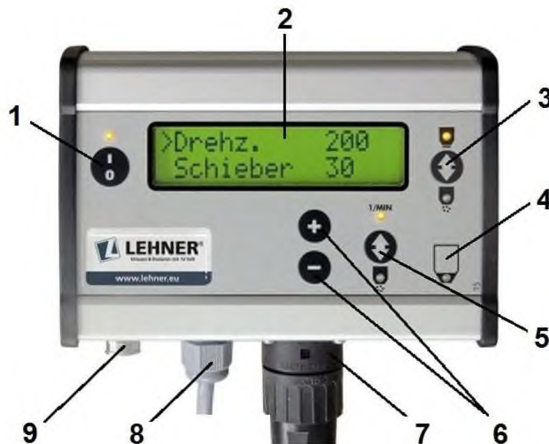
Рис. 11. Пульти керування LAS 4: 1 – кнопка вмикання-вимикання; 2 – дисплей; 3 – кнопка відкриття-закриття заслінки (відповідно зелений-жовтий світлодіод); 4 – індикатор сповіщення про спорожнення бункера; 5 – перемикач між регулюванням частоти обертання розподільного диска і положення заслінки; 6 – кнопки регулювання частоти обертання розподільного диска і положення заслінки; 7 - роз'єм керування робочим процесом висівного модуля; 8 - роз'єм кабеля живлення; 9 – роз'єм підключення системи керування роботою на поворотних смугах (VGM)
