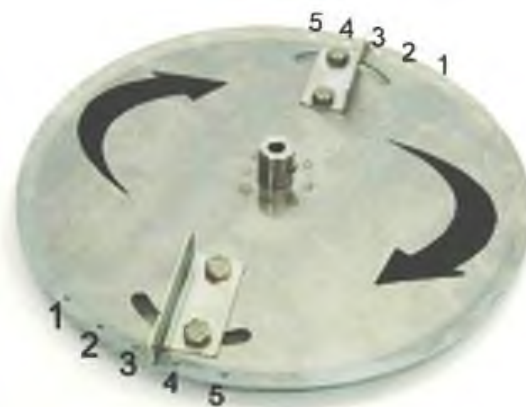
Рис. 14. Загальний вигляд розподільного диска з позначеними мітками для регулювання положення розкидних лопаток
