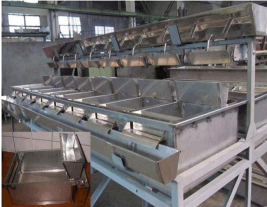
Рисунок 6 – Інкубаційний апарат «Осетер» для інкубації ікри осетрових видів риб
