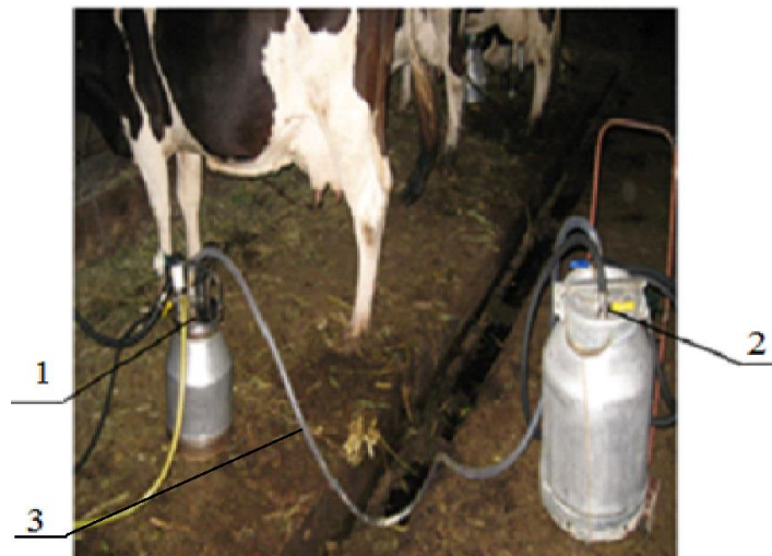
Рис. 5. Експериментальний зразок захисного вузла для транспортування молока: 1 – відро; 2 – бідон; 3 – транспортний молочний шланг.
