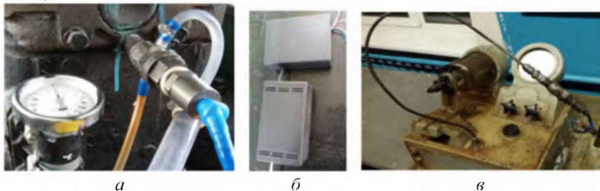
Рис. 1. Загальний вигляд змонтованого на дизелі моделі 4Ч12/14 тензометричного датчика тиску (а), підсилювача з блоком живлення (б) і процесу тарирування датчика на приладі КИ-3333 (в)
