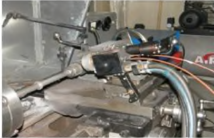
Рис.2. Загальний вигляд апарату для електродугового напилення ЕДН-10
