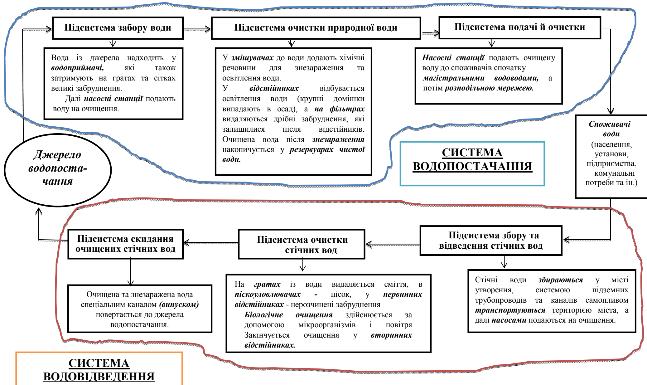
Рис. 1.1. Склад і функції сучасної системи водопостачання та водовідведення для АПК
