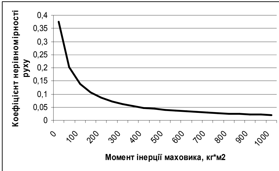
Рис. 6.8. Графік зміни коефіцієнта нерівномірності руху в залежності від зміни моменту інерції маховика
