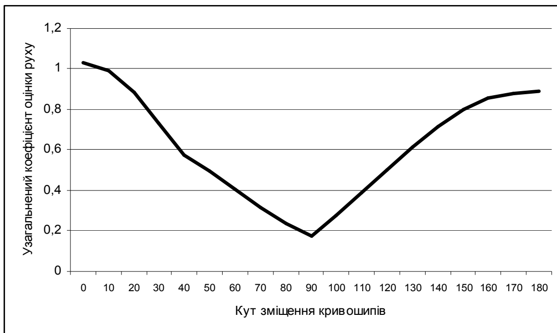
Рис. 6.22. Графік зміни узагальненого коефіцієнта оцінки руху від кута зміщення кривошипів
