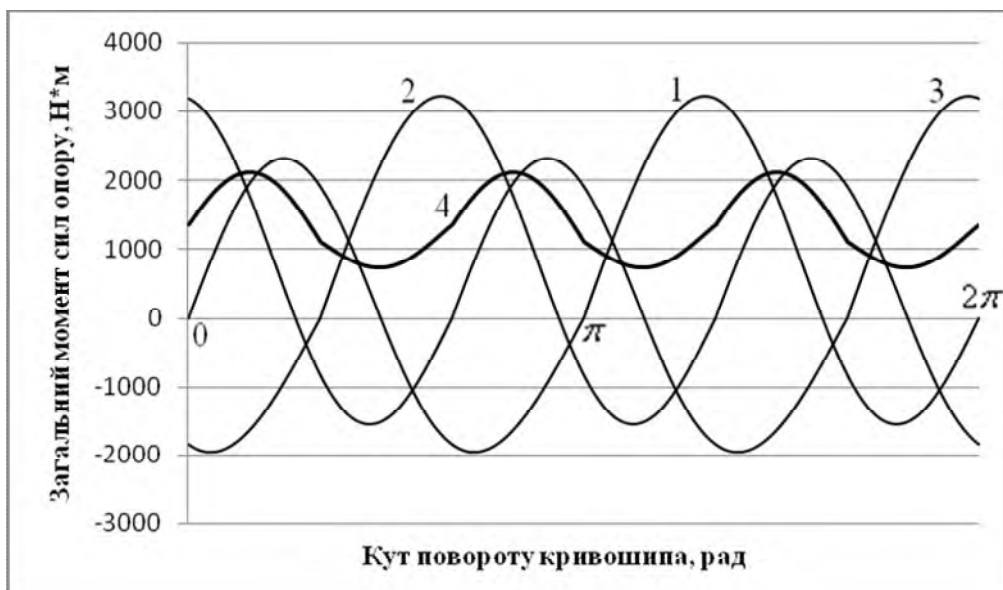
Рис. 3.18. Графіки зміни загального моменту опору установки: 1, 2, 3 – загальні моменти опору першого, другого та третього візків відповідно; 4 – сумарний момент загального опору
