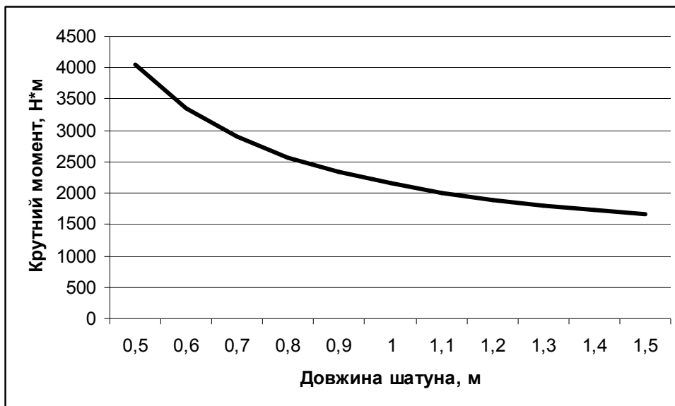
Рис. 4.6. Графік зміни максимального значення загального моменту сил опору M_{заг.макс} в залежності від довжини шатуна
