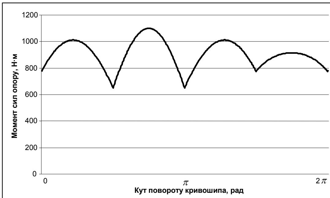
Рис. 6.11. Графік зміни моменту сил опору на переміщення формувальних візків від кута повороту кривошипа
