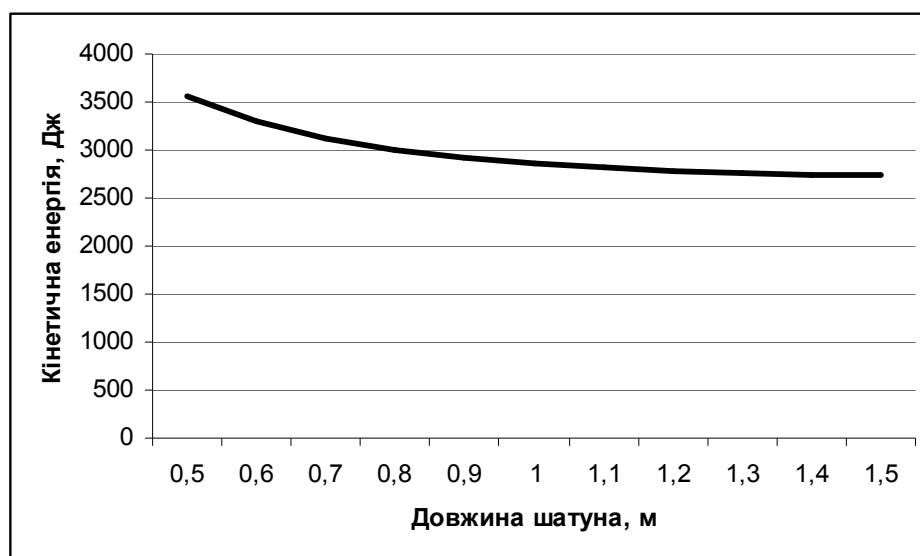
Рис. 4.1. Графік зміни максимального значення кінетичної енергії T_{\text{max}} в залежності від довжини шатуна
