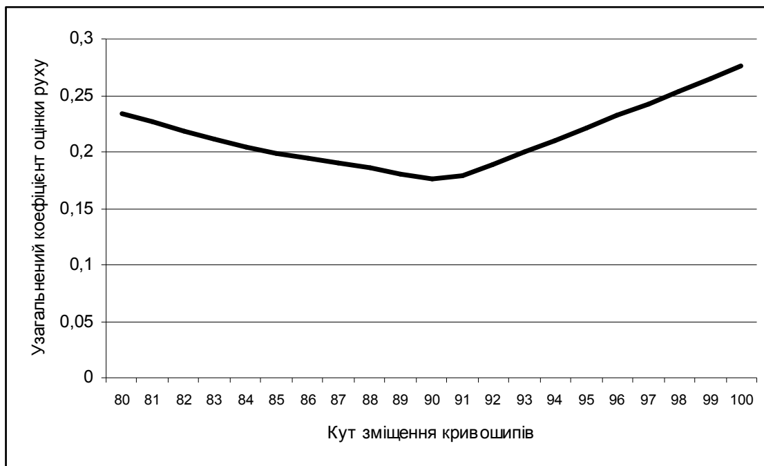
Рис. 6.25. Графік зміни узагальненого коефіцієнта оцінки руху в залежності від кута зміщення кривошипів
