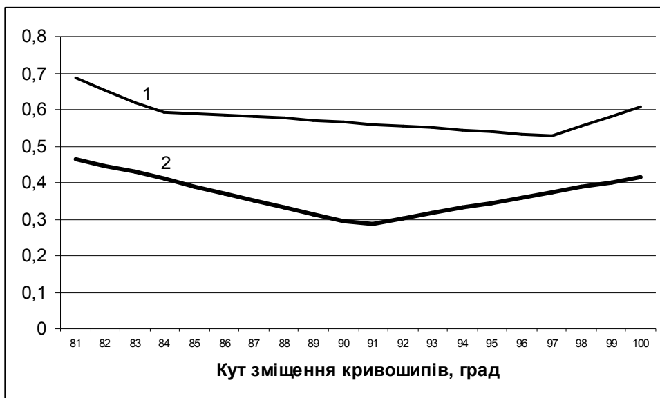
Рис. 3.5. Графіки зміни відносних коефіцієнтів \varepsilon_1 та \varepsilon_2 в залежності від кута зміщення кривошипів в межах від \Delta\varphi = 81^\circ до \Delta\varphi = 100^\circ
