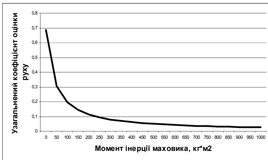
Рис. 6.57. Графік зміни узагальненого коефіцієнта оцінки руху в залежності від зміни моменту інерції маховика
