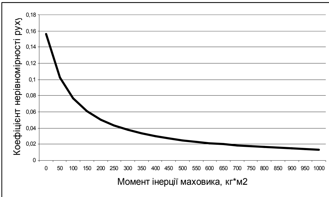
Рис. 6.17. Графік зміни коефіцієнта нерівномірності руху в залежності від зміни моменту інерції маховика
