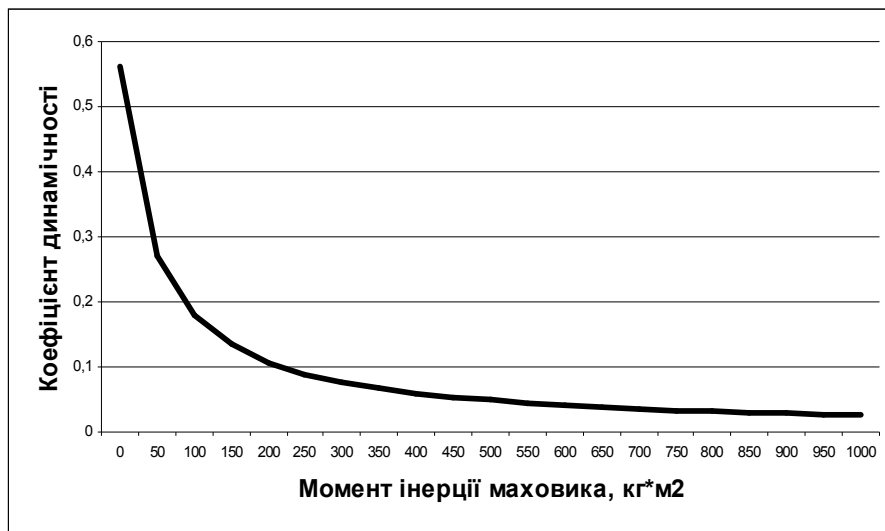
Рис. 6.56. Графік зміни коефіцієнта динамічності в залежності від зміни моменту інерції маховика
