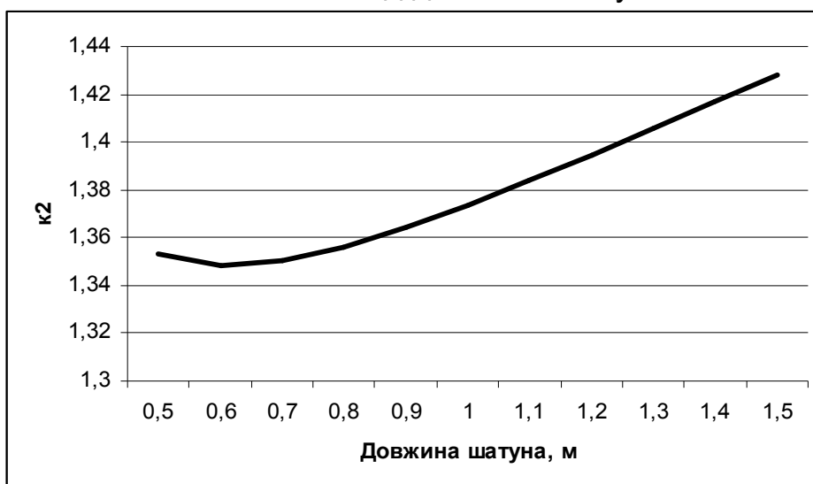
Рис. 4.4. Графік зміни відносного показника k_2 в залежності від довжини шатуна
