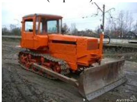
в – бульдозер на базе ДТ-75
