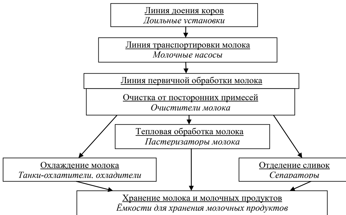
Рис. 12.11. Конструктивно-технологическая схема процесса производства молока и первичной обработки молока на молочной ферме
