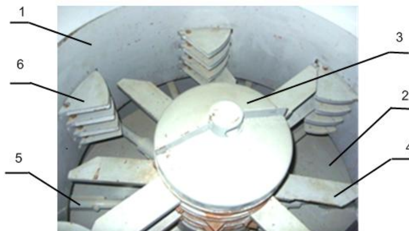
Рис. 4.4. Измельчитель-смеситель с пальцевой швырялкой:
