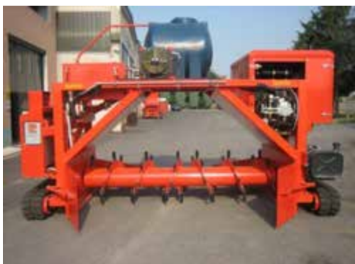
д – самоходный смеситель-аэратор фирмы CARAVAGGI SRL (Италия)
