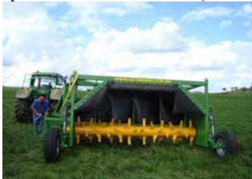
ж – прицепной смеситель-аэратор фирмы Sittler (Австралия)
