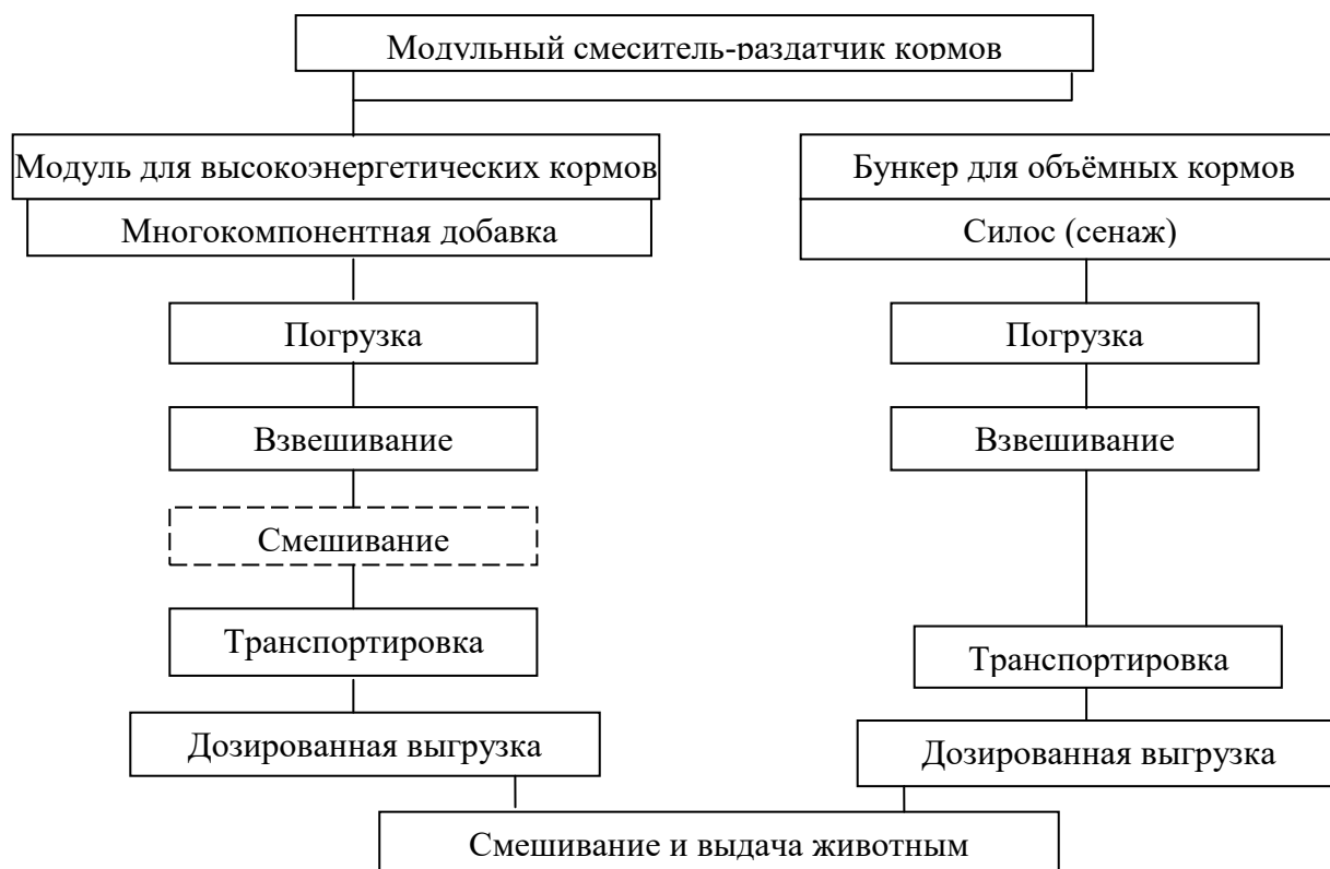
Рис. 7.17. Пооперационная схема рабочего процесса мобильного модульного смесителя-раздатчика кормов
