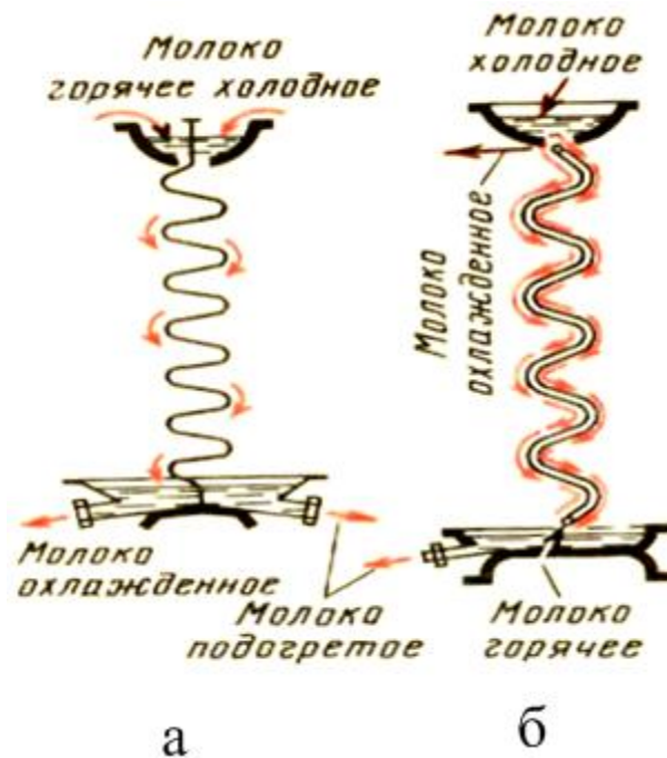
Рис. 10.15. Открытые регенераторы молока: а – прямоточный («зигзаг»); б – противоточный
