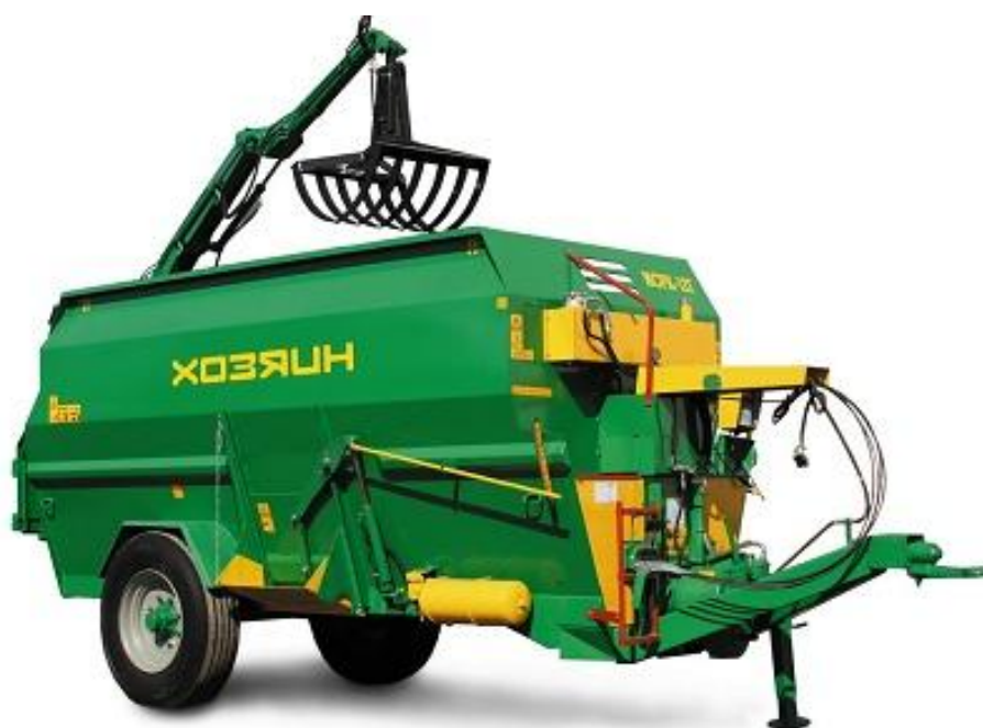
Рис. 7.9. Измельчитель-смеситель-раздатчик с грейферным захватом
