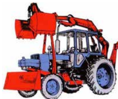
б – погрузчик периодического действия ПЭ-Ф-1А (Украина)
