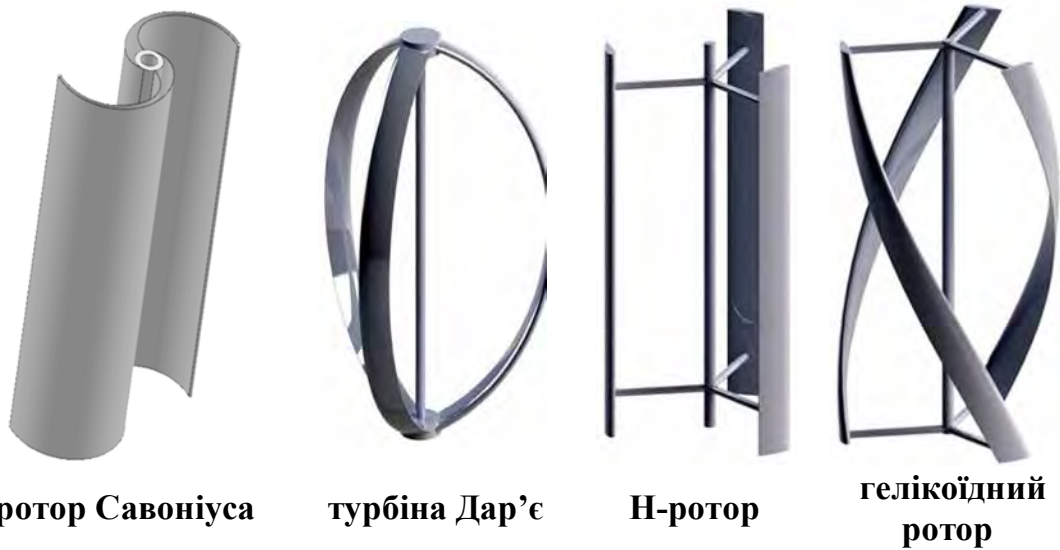
Рис. 9.6. Типи роторів вітрогенератора з вертикальною віссю
