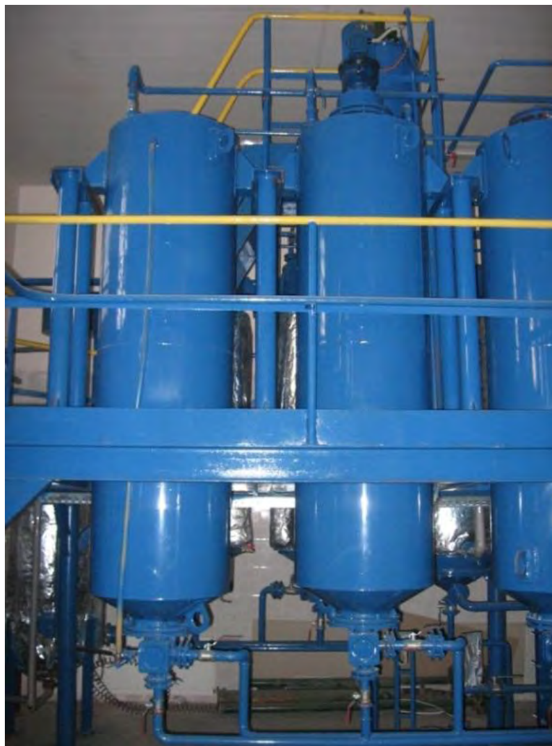
Рис 2.8. Обладнання для виробництва дизельного біопалива продуктивністю 300 т/рік
