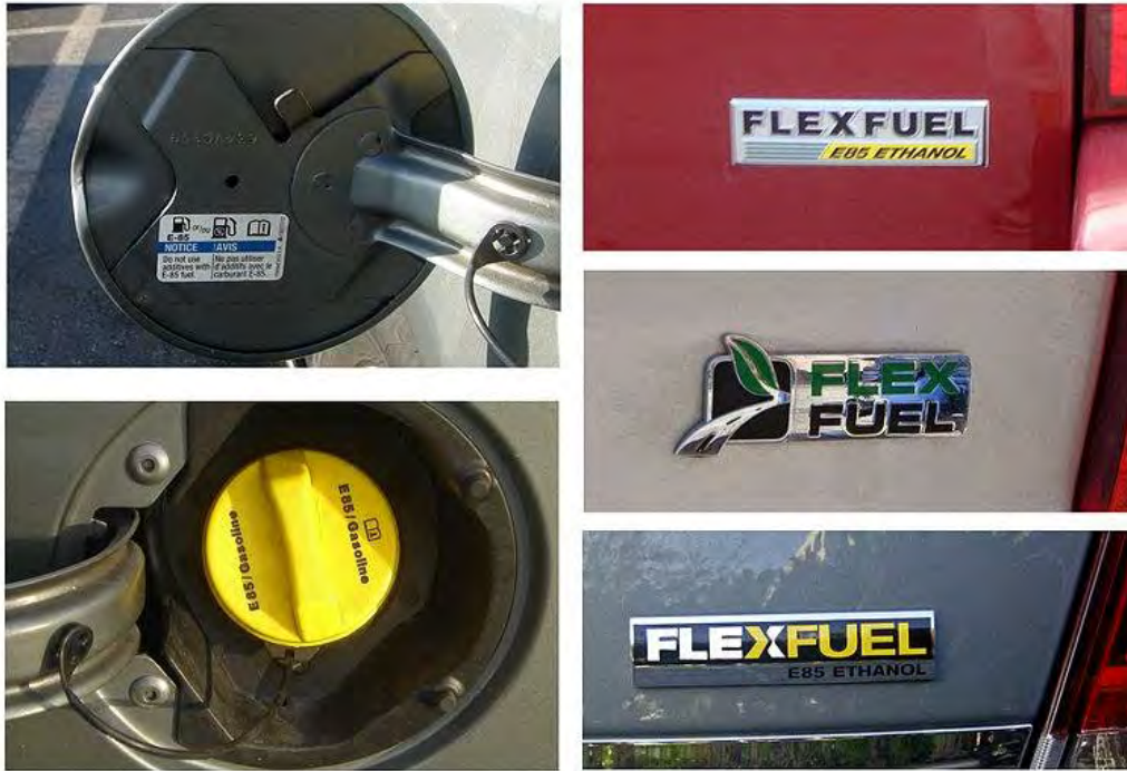
Рис. 3.12. Маркування сучасних багатопаливних автомобілів, які приданні для використання біоетанолу
