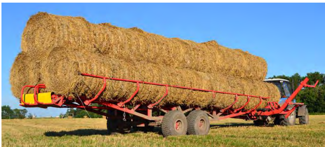
Рис. 5.6. Транспортний причіп для доставки тюків в місця зберігання
