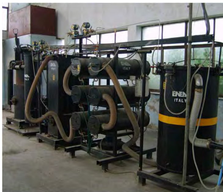
Рис. 7.19. Газогенераторна установка ENEA (виробництво Італії) силовою потужністю 80 кВт, яка працює на деревинних відходах вологістю від 25 до 30 %
