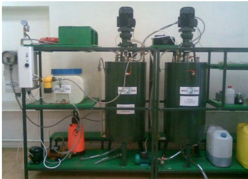
Рис. 2.7. Обладнання для виробництва дизельного біопалива продуктивністю 100 л/год.
