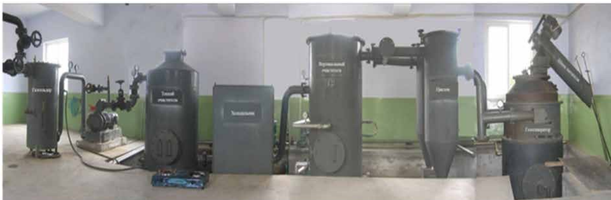
Рис. 7.17. Газогенераторна установка тепловою потужністю 300 кВт, що працює на рослинних залишках сільськогосподарського виробництва вологістю до 40 % (розробка Ліаонінського інституту енергетичних ресурсів (КНР))
