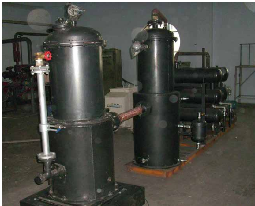
Рис. 7.18. Газогенераторна установка силовою потужністю 50 кВт, яка працює на деревинних рослинних залишках вологістю до 40 % (розробка Ліаонінського інституту енергетичних ресурсів (КНР))
