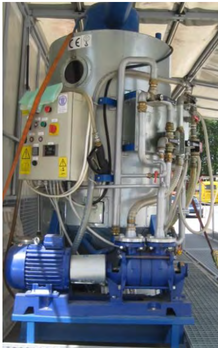
Рис. 2.17. Естерифікатор для виробництва дизельного біопалива в умовах фермерських господарств (Польща)
