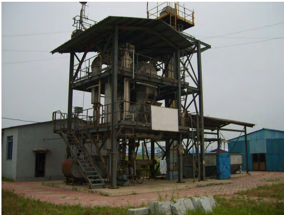
Рис. 7. 21. Газогенераторна станція (виробництво КНР) силовою потужністю 350 кВт, яка працює на залишках сільськогосподарського виробництва вологістю до 30 %
