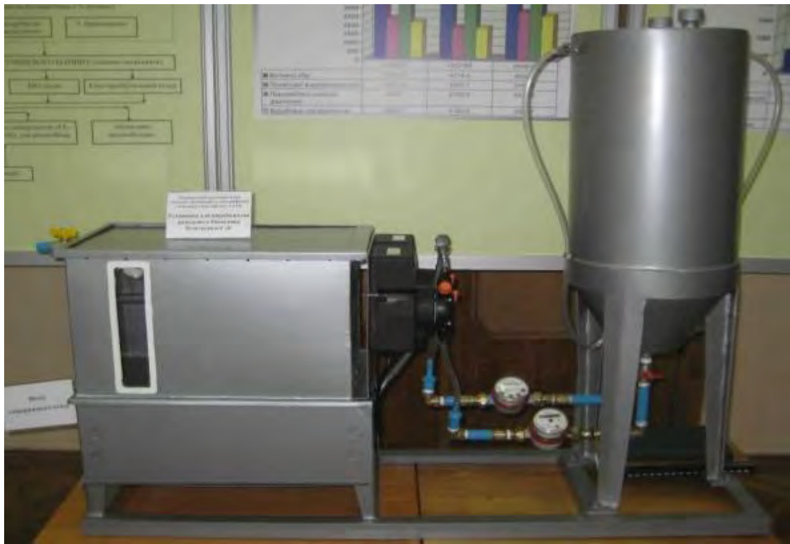
Рис. 2.6. Обладнання для виробництва дизельного біопалива УБ-ТР-20 продуктивністю 5 л/год.
