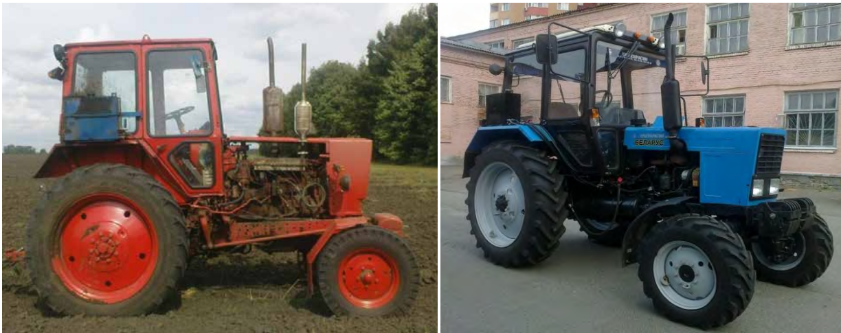
Рис. 2.27. Трактори ПМЗ-6 АКЛ та Кий-14102 обладнані системою двоступеневого підігріву палива
