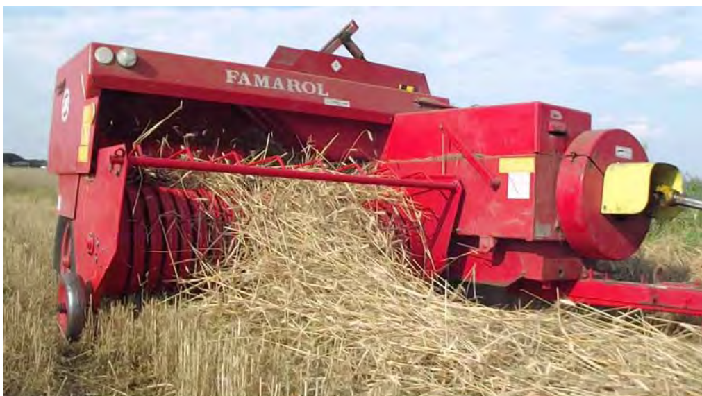
Рис. 5.3. Прес-підбирач поршневого типу для формування малогабаритних тюків, марки FAMAROL Z-511 (Unia Group)
