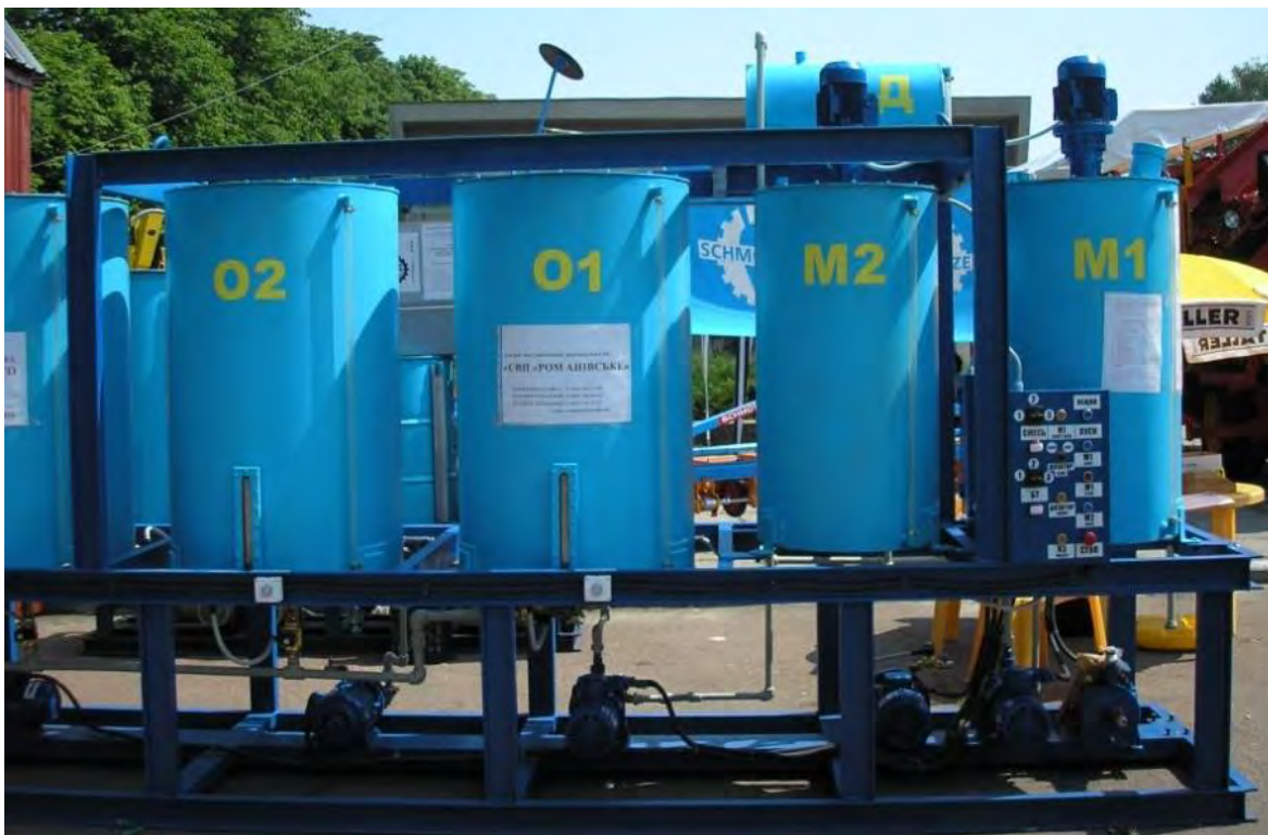
Рис. 2.5. Установка для одержання дизельного біопалива із рослинних олій продуктивністю 1000 т/рік УВМЕ-100
