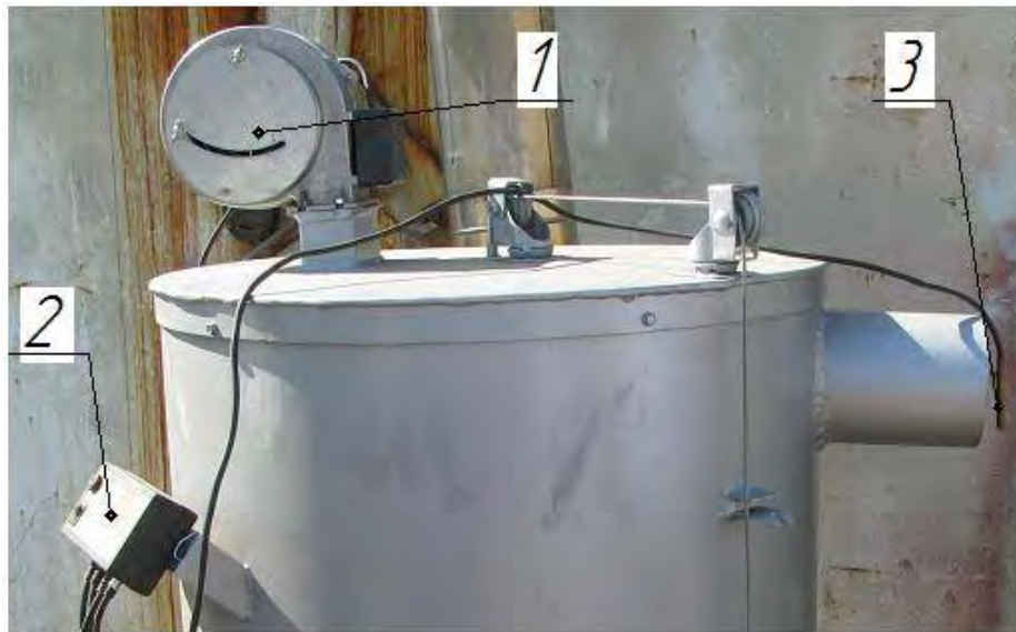
Рис. 5.19. Котел для спалювання соломи із верхнім горінням
