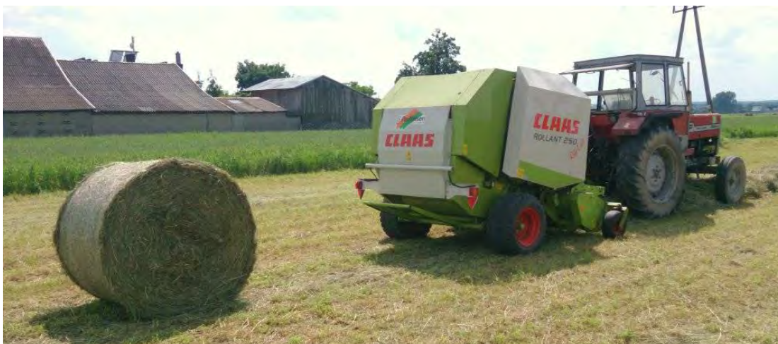
Рис. 5.4. Прес-підбирач рулонного типу для формування тюків середнього та великого типорозмірів, марки Rollant 250 (Claas)
