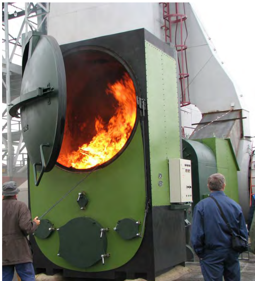
Рис. 5.15. Газогенераторний опалювальний котел для тюків фірми HERLT
