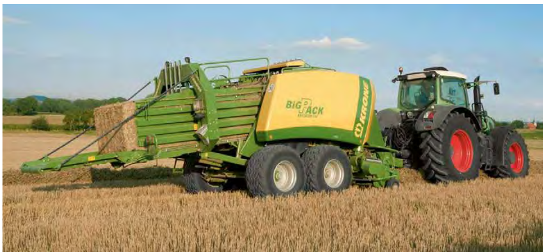
Рис. 5.5. Прес-підбирач поршневого типу для формування тюків середнього та великого типорозмірів, марки Krone "BigPack VFS1290"
