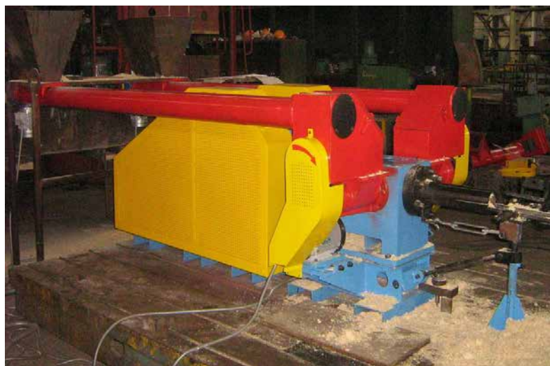
Рис. 5.9. Машина брикетувальна В-80 виробництва ВАТ «Пресмаш» (Україна)
