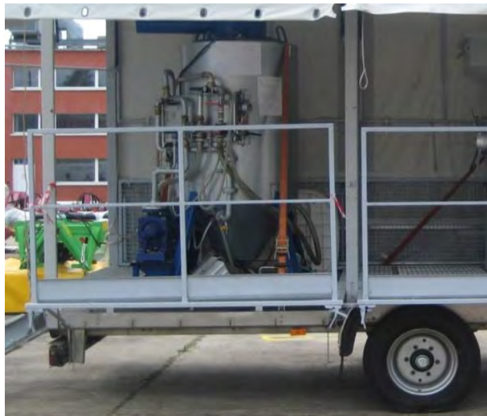
Рис. 2.18. Мобільне обладнання для виробництва дизельного біопалива W500M
