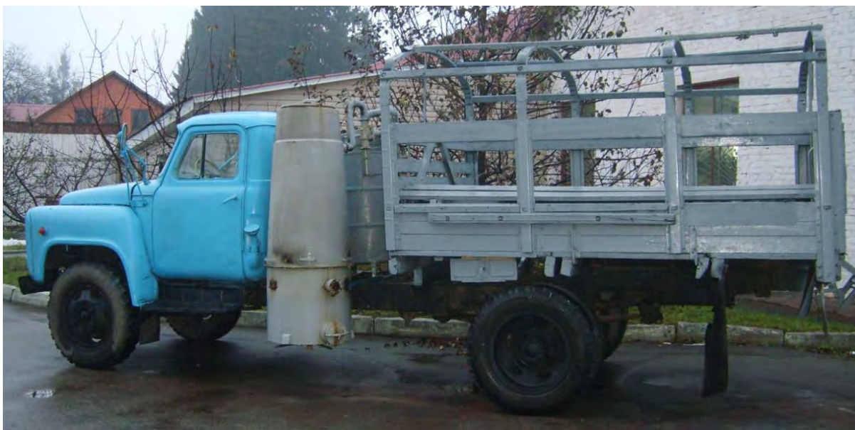
Рис. 7.25. Автомобіль ГАЗ-53А з газогенераторною установкою виробництва Житомирського національного агроєкологічного університету
