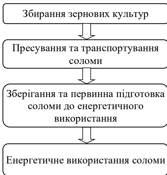
Рис. 5.1. Технологічний ланцюг енергетичного використання соломи
