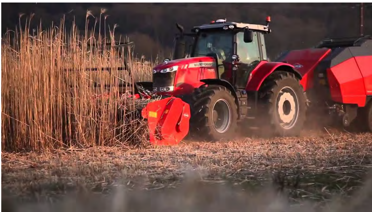
Рис. 6.8. Скошування та тюкування трав'янистих енергетичних культур
