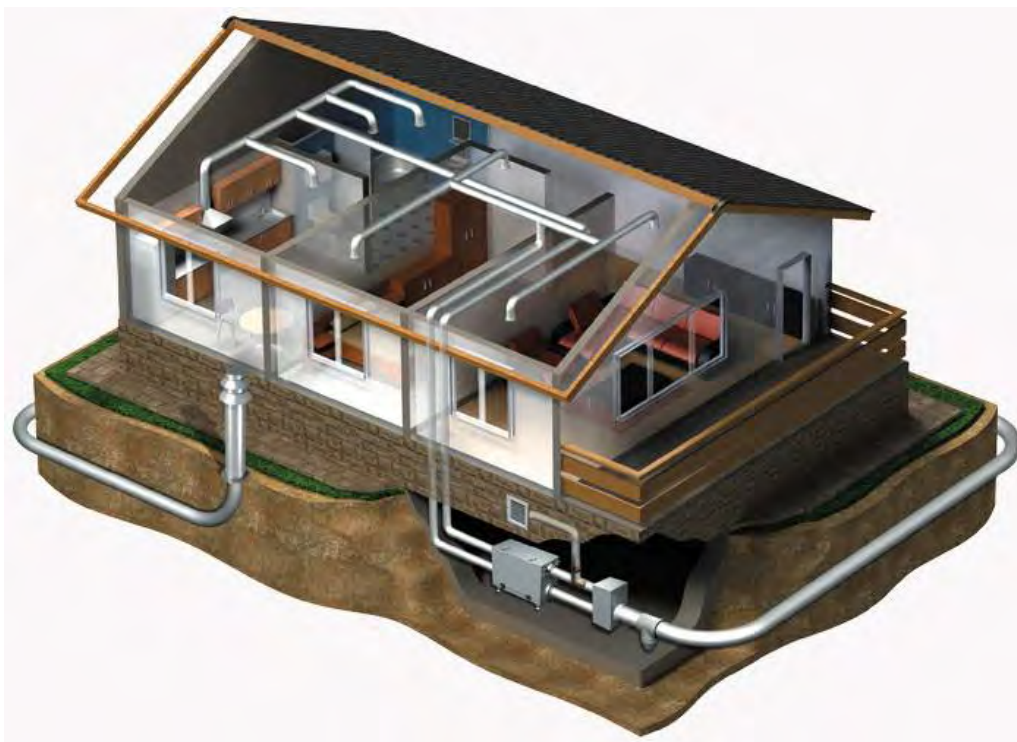
Рис. 8.17. Система геотермальної вентиляції
