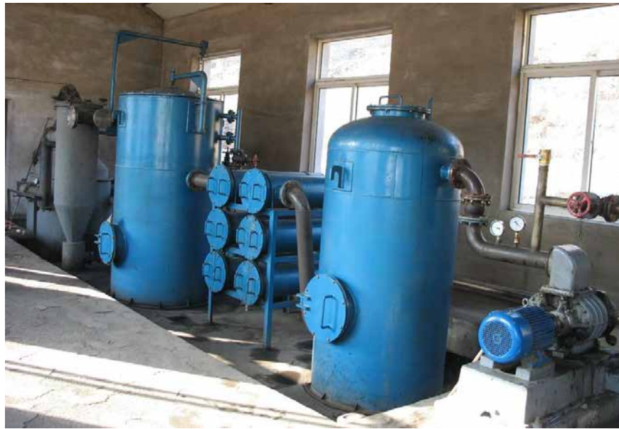
Рис. 7.16. Газогенераторна установка потужністю 200 кВт, що працює на рослинних залишках сільськогосподарського виробництва вологістю до 30 % (розробка Ліонінського інституту енергетичних ресурсів (КНР))
