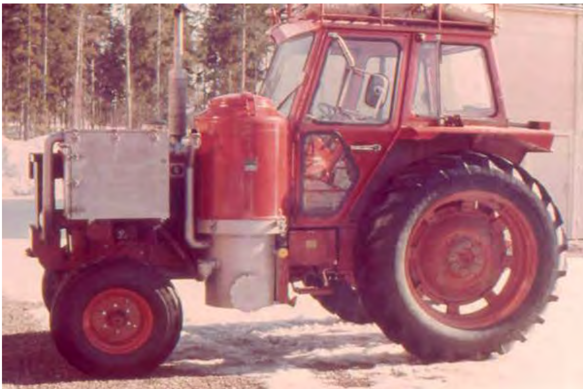
Рис. 7.23. Газогенераторний трактор фірми Volvo, який працює на пелетованих рослинних відходах
