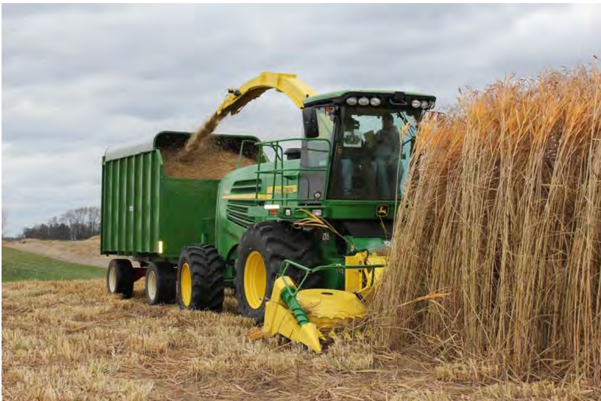
Рис. 6.9. Збирання трав'янистих енергетичних культур кормозбиральним комбайном
