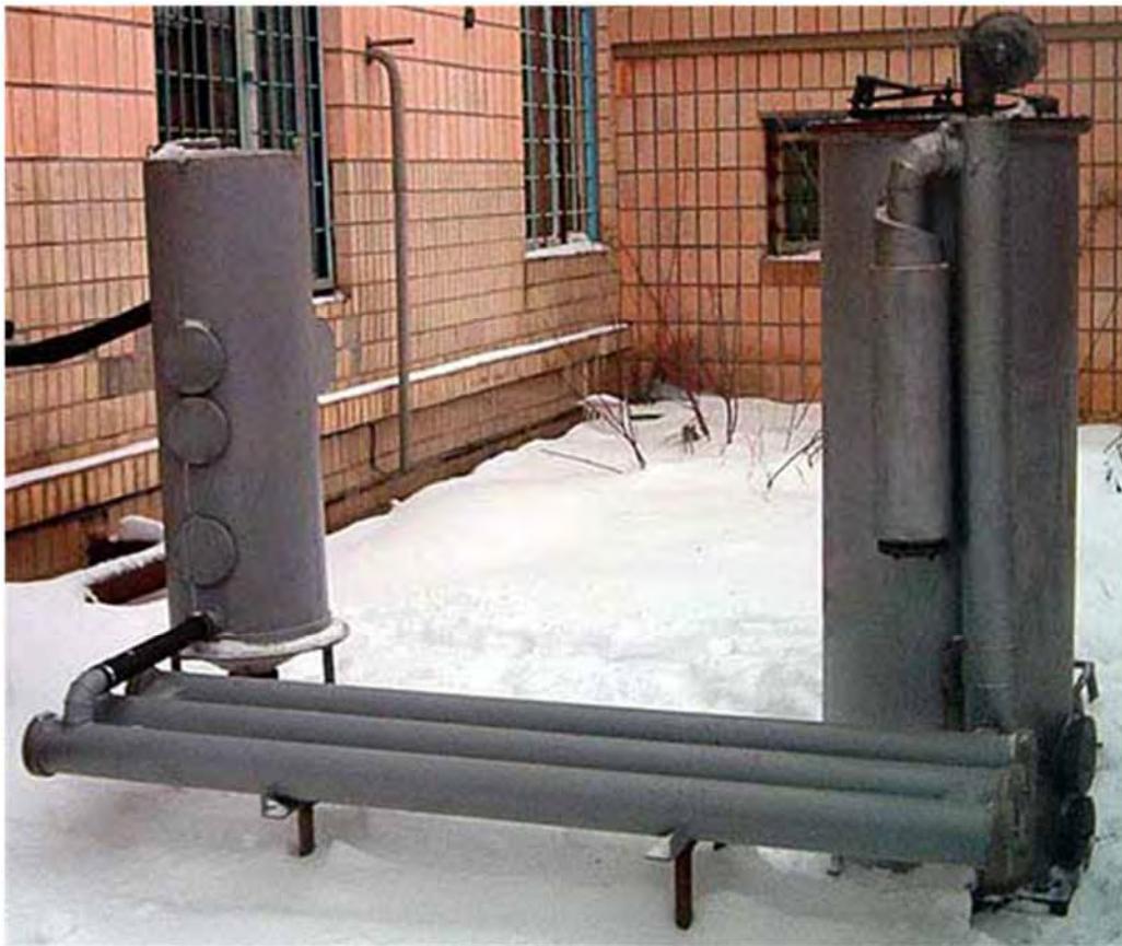
Рис. 7.24. Газогенераторна установка виробництва української фірми «АТТИК», тепловою потужністю 90 кВт, яка працює на відходах деревної біомаси вологістю до 25 %
