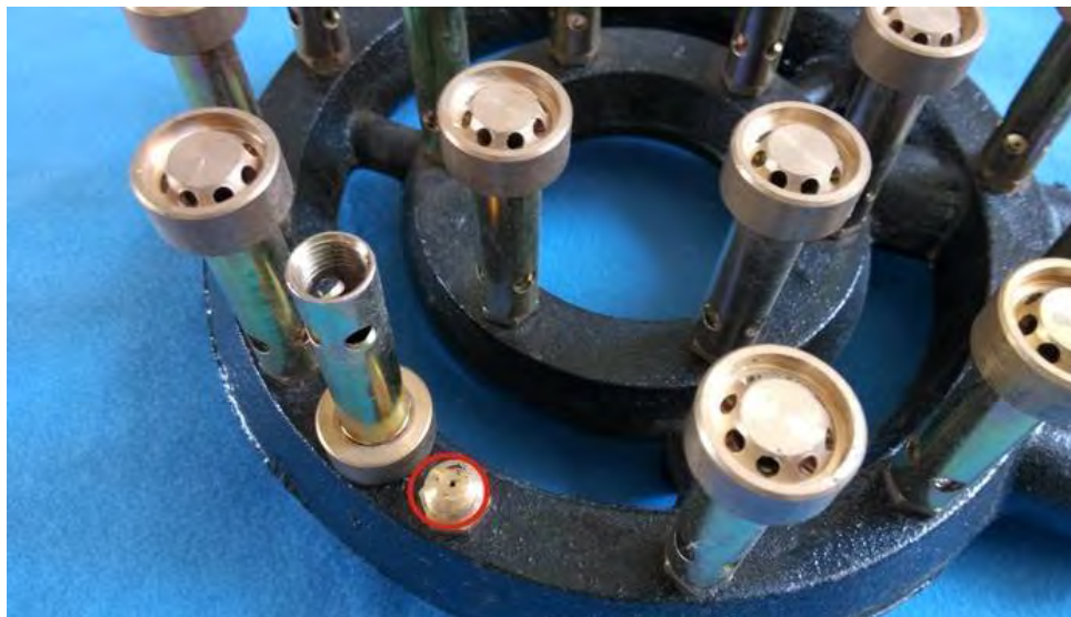
Рис. 4.18. Пальник біогазової кухонної плити
