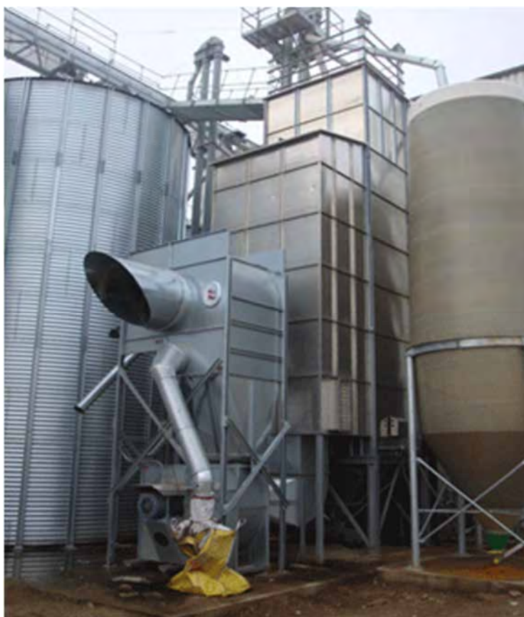
Рис. 4.19. Зернова сушарка із використанням біогазу
