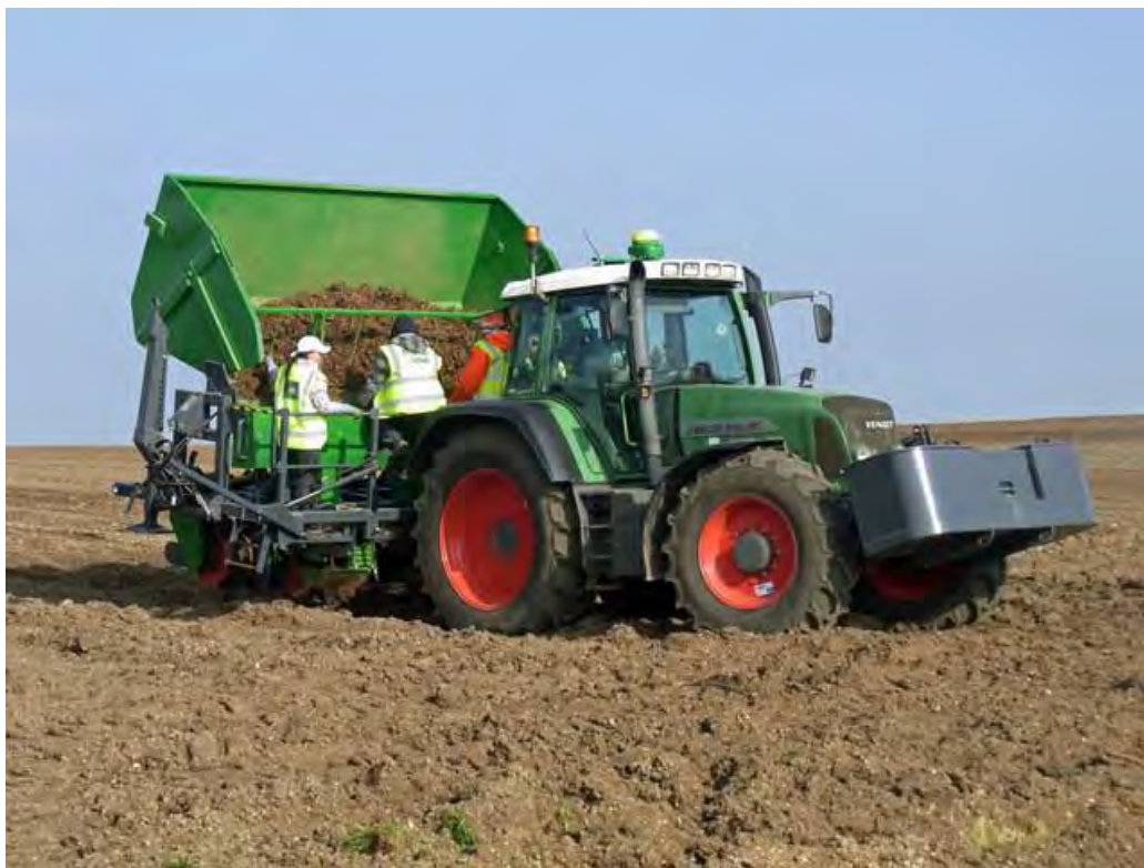
Рис. 6.7. Висаджування кореневищ міскантусу за допомогою картоплесаджалки
