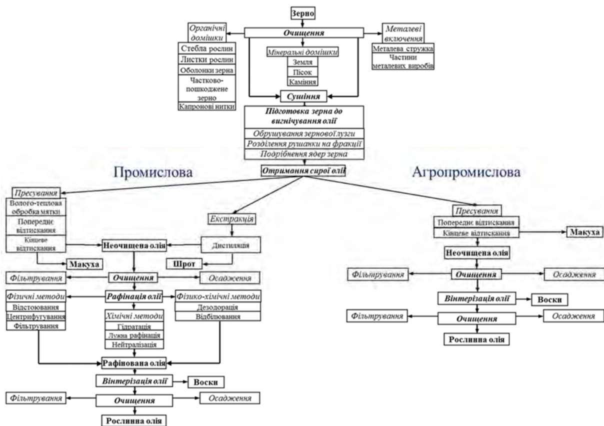
Рис. 2.1. Схема виробництва рослинної олії
