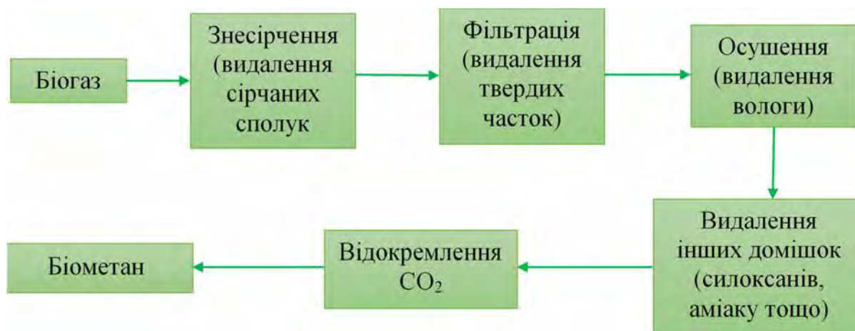
Рис. 4.23. Етапи очищення та збагачення біогазу
