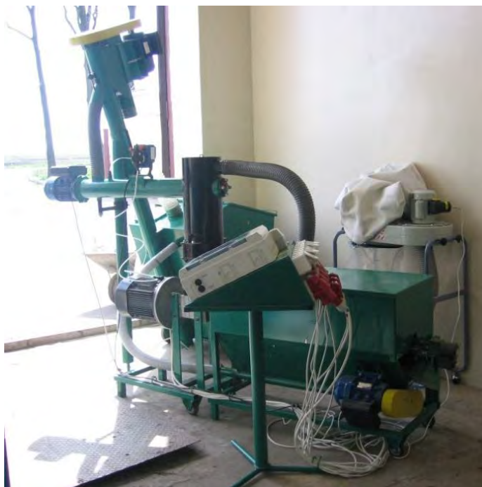
Рис. 5.8. Лінія гранулювання біомаси ECO-BIO-100 виробництва НУБіП України (Чехія-Україна)
