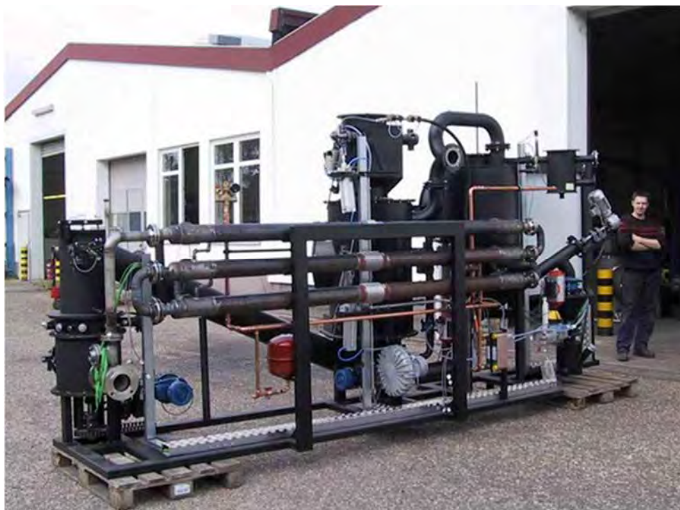
Рис. 7. 20. Газогенераторна установка фірми Spanner RE GmbH силовою потужністю 100 кВт, яка працює на деревних відходах вологістю до 30 %
