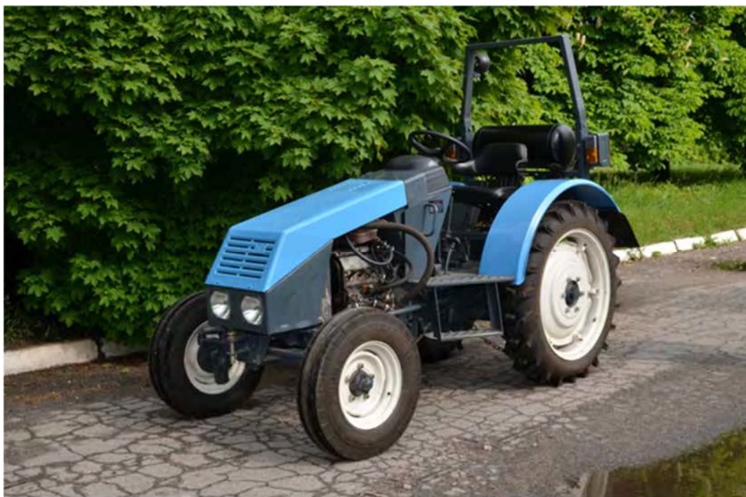
Рис. 3.11. Багатопаливний трактор ХТЗ- 2511G
