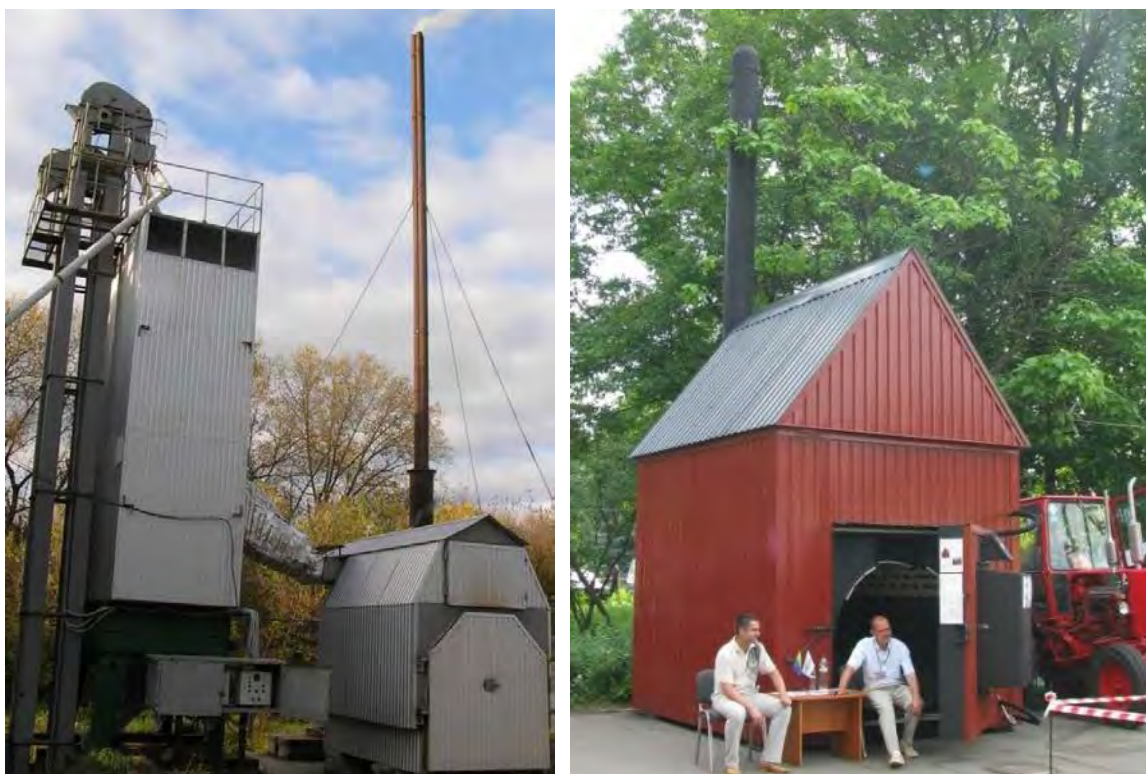
Рис. 5.14. Зерносушарка з теплогенератором ТГС-500 у навчально-дослідному господарстві НУБіП України «Агрономічна дослідна станція» та опалювальний котел на соломі виробництва ЮТЕМ
