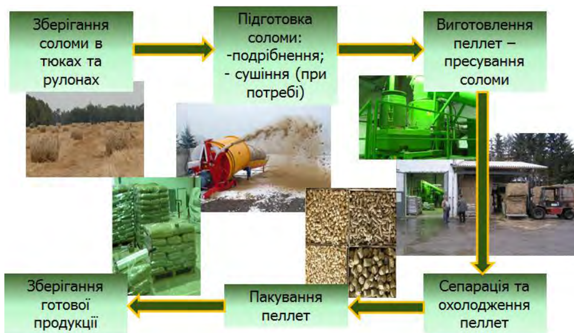
Рис. 5.10. Технологічний процес виробництва пеллет із соломи
