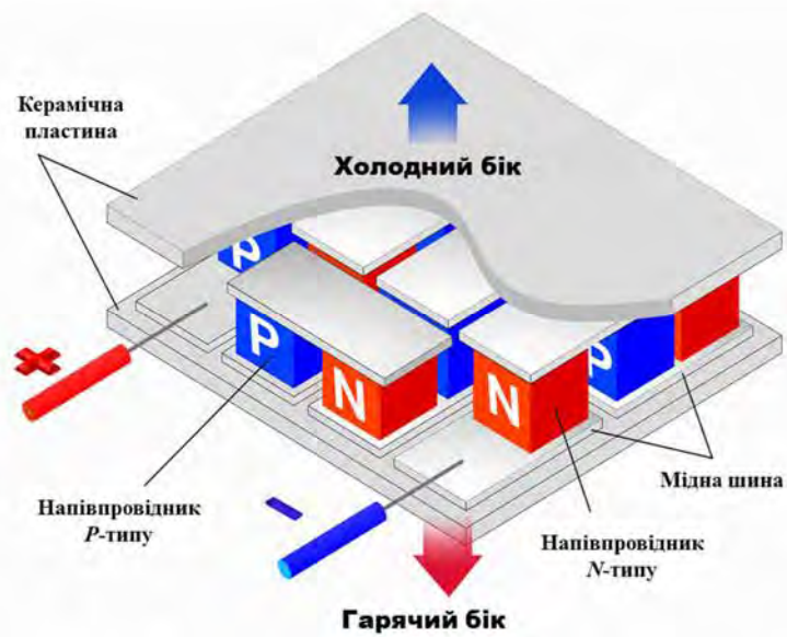
Рис. 8.8. Структура термоелектричного модуля
