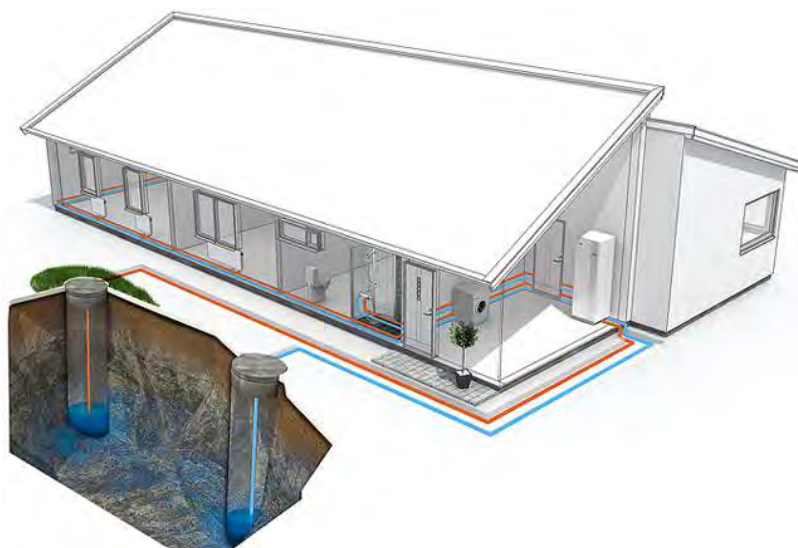
Рис. 8.12. Схема теплового насоса з використанням тепла ґрунтових вод
