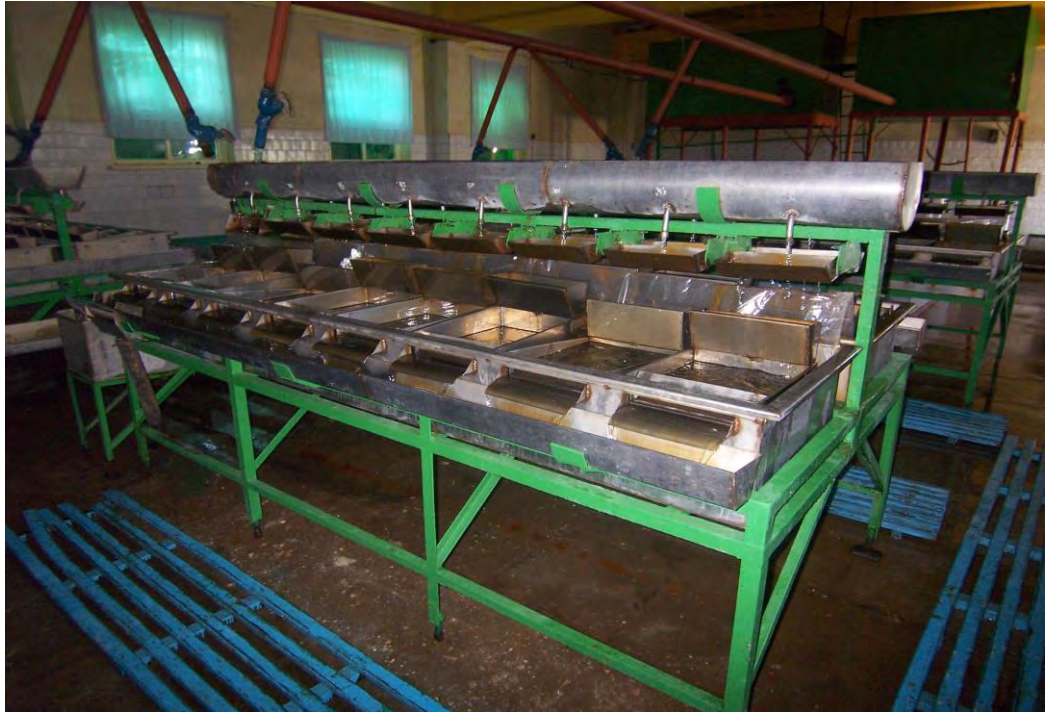
Інкубаційний апарат «Осетер»
