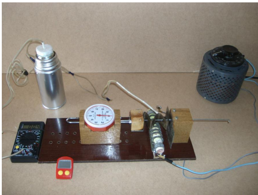
Рис. 8.29. Зовнішній вигляд установки для дослідження приводних елементів із ФС
