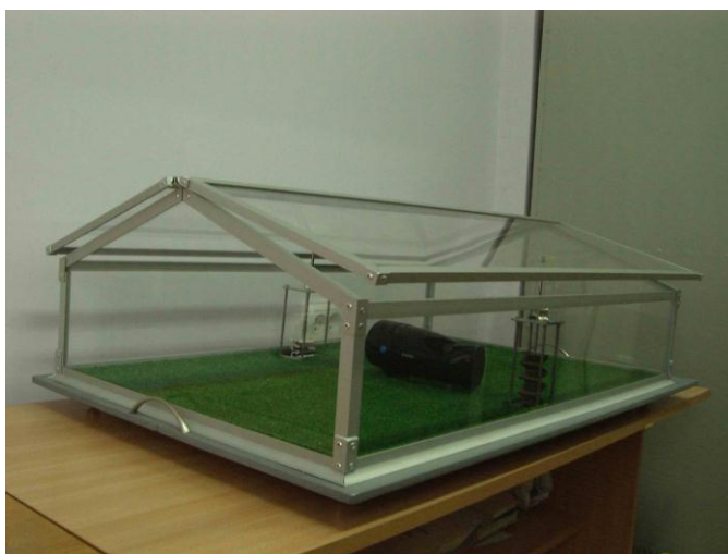
Рис.8.17. Модель парника з приводами на основі ФС
