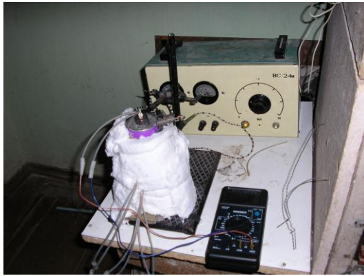
Рис.8.10. Установа для визначення коефіцієнта теплопровідності: а – до теплоізолювання; б – після теплоізолювання
