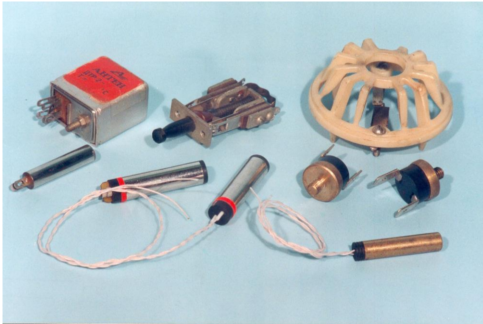
Рис.7.9. Загальний вигляд термореле з термочутливими елементами із сплаву з ЕПФ
