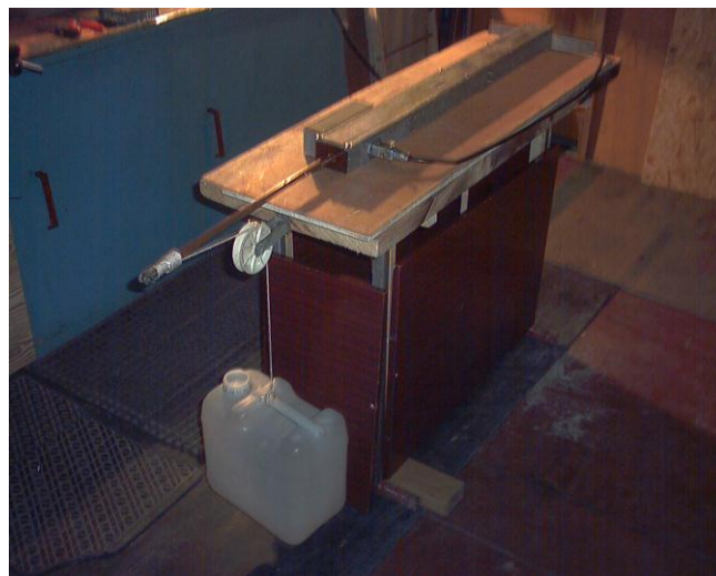
Рис.8.42. Дослідна установка для визначення переміщення штока приводу при постійному навантаженні
