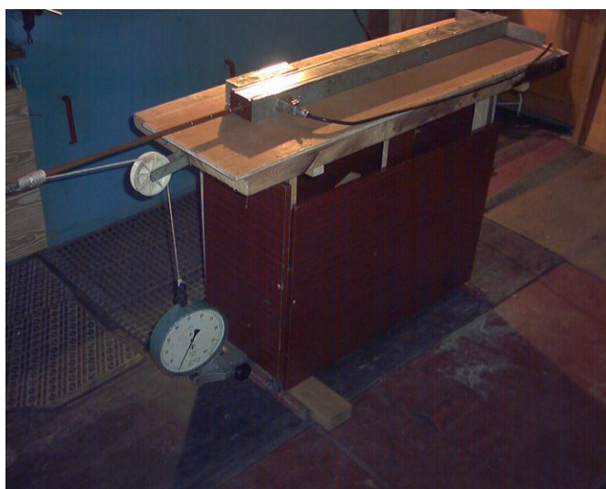
Рис.8.39. Дослідна установка для визначення зусилля електротермомеханічного приводу
