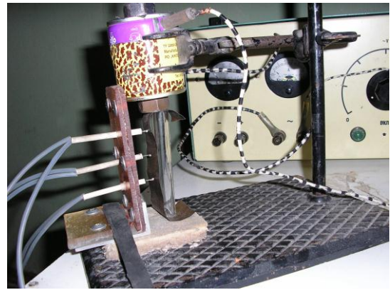
Рис.8.10. Установа для визначення коефіцієнта теплопровідності: а – до теплоізолювання; б – після теплоізолювання
