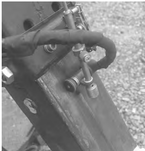
Рис. 3.18. Розміщення датчиків лінійного переміщення на фізичній моделі: а) датчик переміщення штоку гідравлічного циліндра приводу стріли; б) датчик переміщення штоку гідравлічного циліндра приводу рукояті; в) датчик переміщення штоку гідравлічного циліндра приводу телескопічної секції
