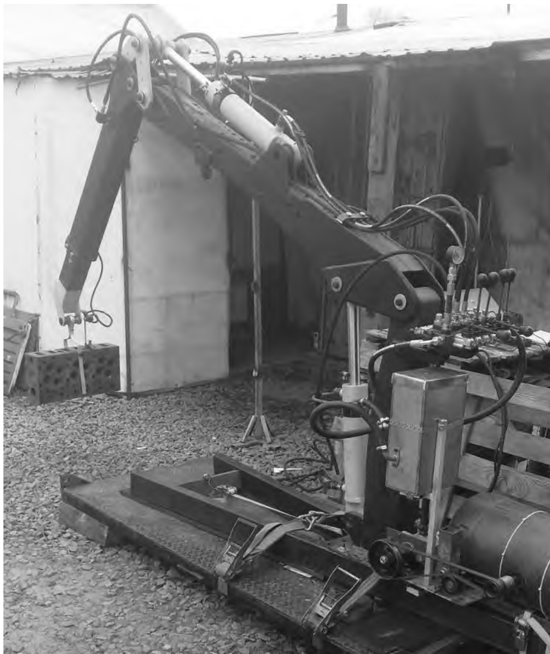
Рис. 3.1. Розроблена експериментальна установка крана-маніпулятора з гідравлічним приводом
