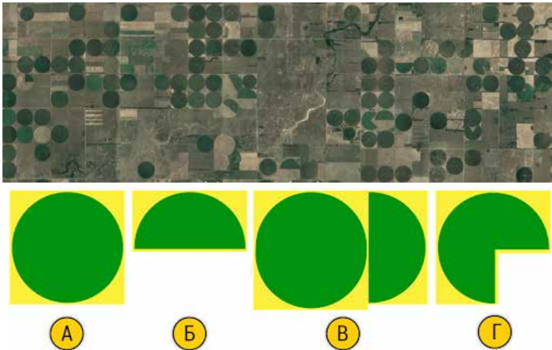
Рисунок 8.16. Робота дощувальної машини кругової дії на полях різної конфігурації: А – квадратної форми, Б, В – прямокутної форми, Г – нестандартної форми
