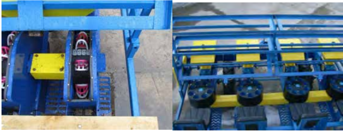
Рисунок 7.8. Ліворуч – Ложечково-транспортний висаджувачий апарат картоплесаджалки СПК-6. Праворуч – Револьверний висаджувачий апарат картоплесаджалки СКН-4
