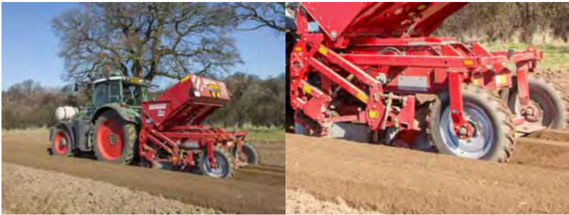
Рисунок 7.29. Гребенеутворююча плита Flow-Board сажалки GB 215
