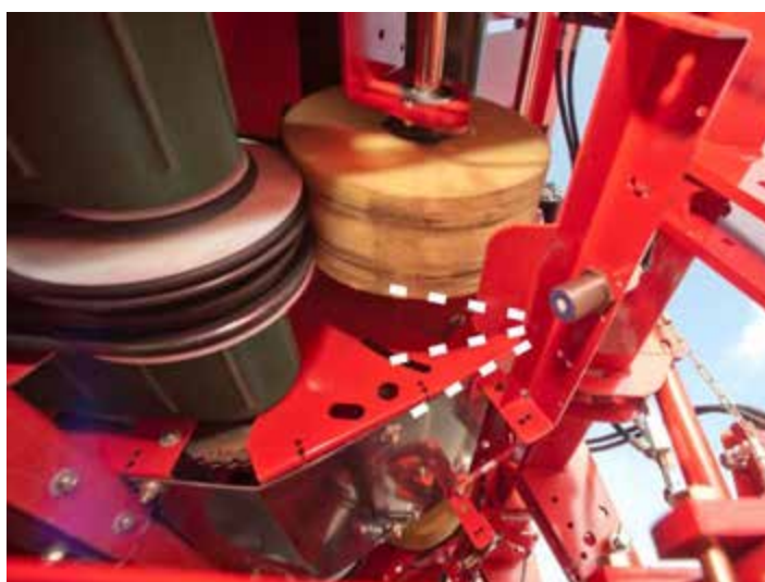
Рисунок 7.20. Контроль садіння у сажалки GB 215
