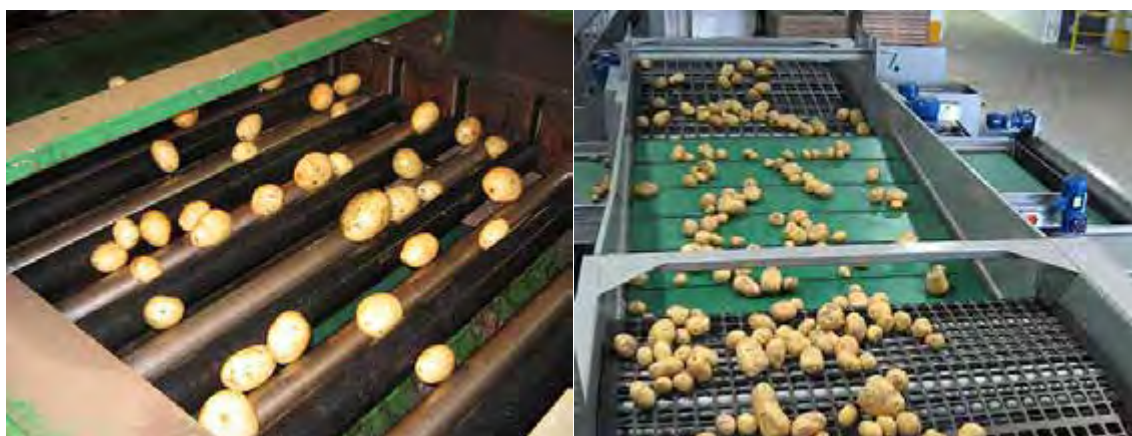
Рисунок 9.21. Ліворуч – сортувалки із поперечними роликами. Праворуч – сортувалки із квадратними отворами
