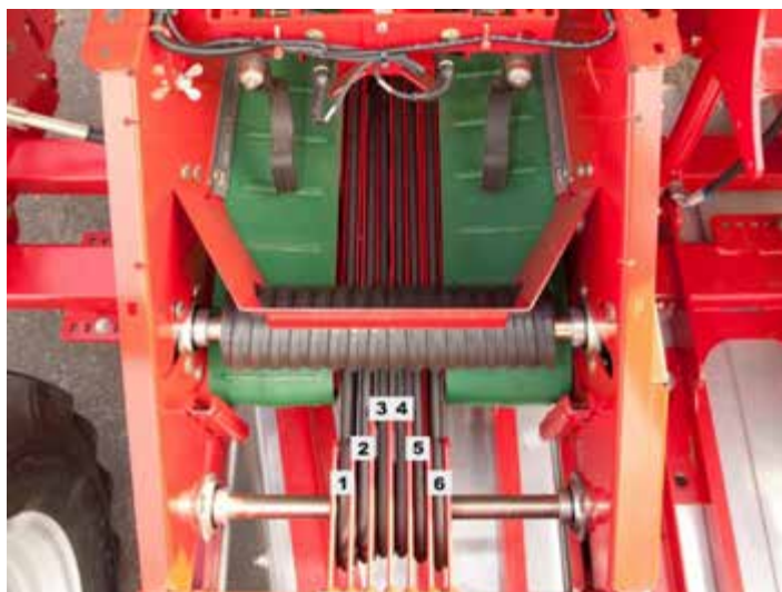
Рисунок 7.13. Висажуючі ремені сажалки GB 215
