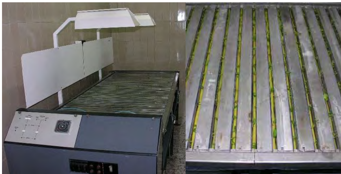
Рисунок 11.19. Гідропонна установка «Мінівіт» (ліворуч). Регенеранти в установці (праворуч)
