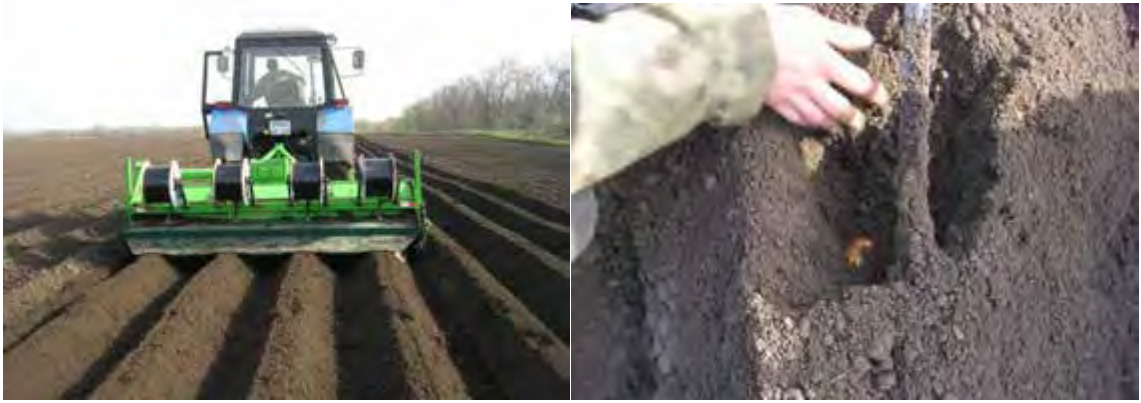
Рисунок 8.22. Прокладання краплинної стрічки у ґрунт при формуванні гребенів
