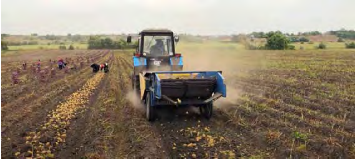
Рисунок 9.11. Підкопування картоплі картоплекопач УКВ-2
