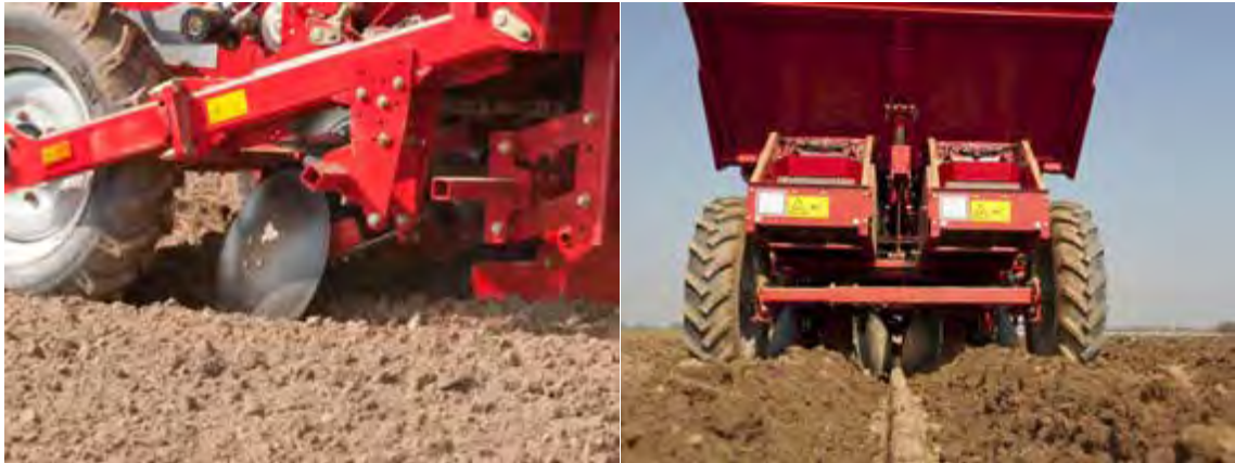
Рисунок 7.27. Дискові загортачі сажалки GB 215
