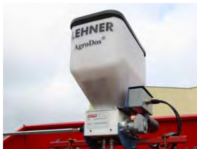
Рисунок 7.24. Точне внесення мінеральних добрив сажалки GB 215
