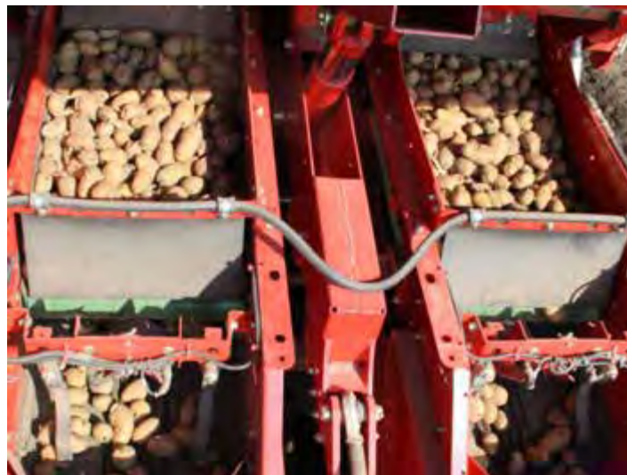
Рисунок 7.11. Подавальний транспортер сажалки GB 215
