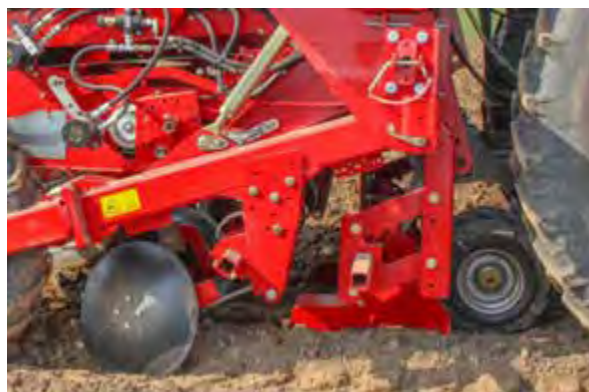
Рисунок 7.26. Сошник сажалки GB 215
