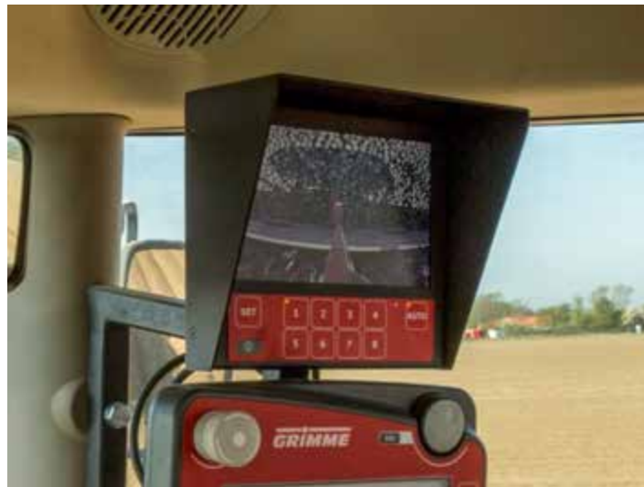
Рисунок 7.23. Система відеоконтролю GRIMME
