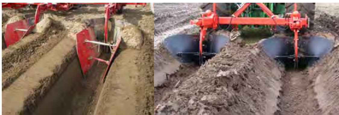
Рисунок 4.5. Ліворуч – Корпус плуга BFL для легких ґрунтів. Праворуч – Корпус плуга BF для середніх і важких ґрунтів
