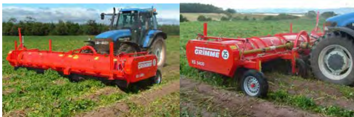
Рисунок 9.2. Машина для видалення стебла GRIMME KS 5400
