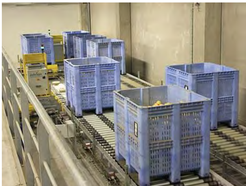
Рисунок 9.28. Комп'ютерна система знає, куди відправити контейнер з картоплею завдяки штрихкодам, розташованих на стінці кожного контейнера
