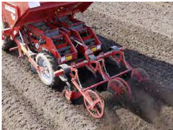
Рисунок 7.28. Решітчастий каток сажалки GB 215
