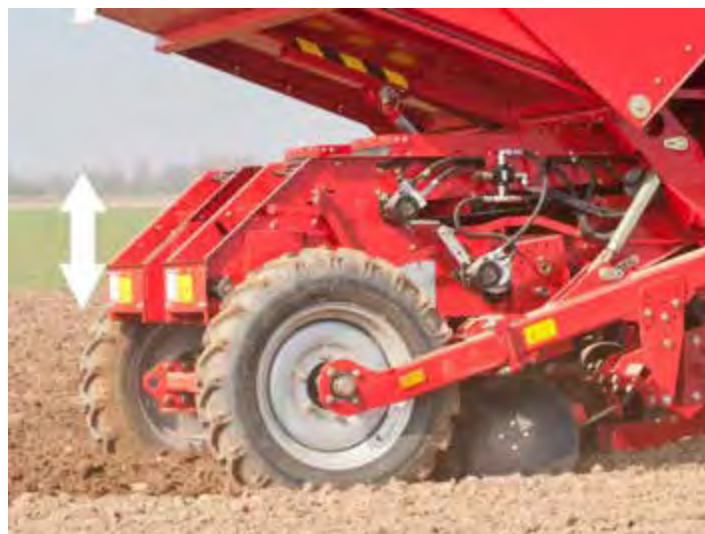
Рисунок 7.22. Автоматичне регулювання нахилу сажалки GB 215
