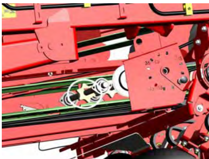
Рисунок 7.15. Струшувач круглих ременів сажалки GB 215
