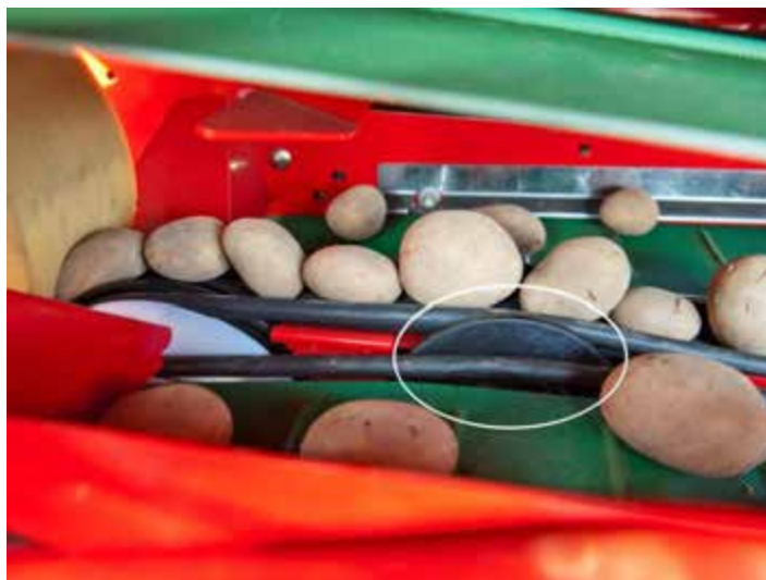
Рисунок 7.14. Регулювальний диск для адаптації відстані між ременями сажалки GB 215
