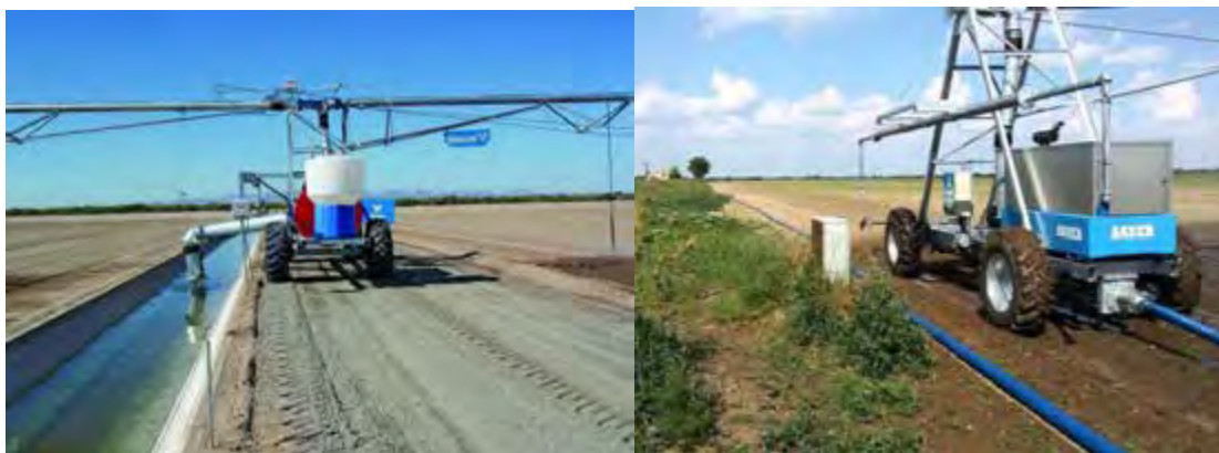
Рисунок 8.17. Загальний вигляд дощувальних машин з забором води з зрошувального каналу (ліворуч) та з гідранту напорної зрошуваної мережі (праворуч)
