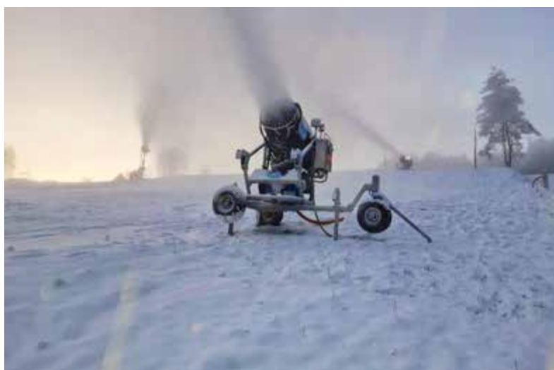
Рисунок 8.25. Загальний вигляд снігогенератора
