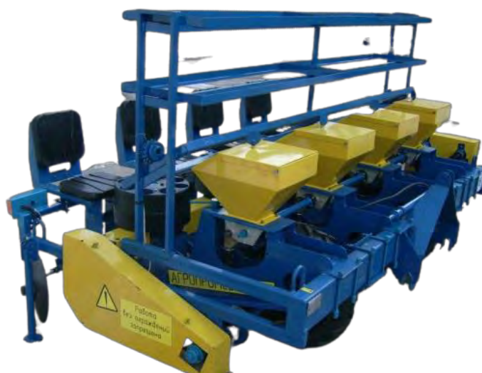
Рисунок 7.5. Картоплесаджалка для пророщених бульб СКН-4
