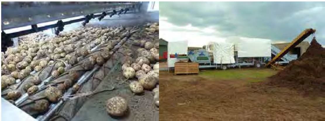
Рисунок 9.19. Ліворуч – вали сепарувальних дисків. Праворуч – відведення ґрунту й дрібних домішок за межі сортувального пункту
