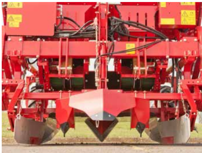
Рисунок 7.30. Розділювач гряди сажалки GB 215
