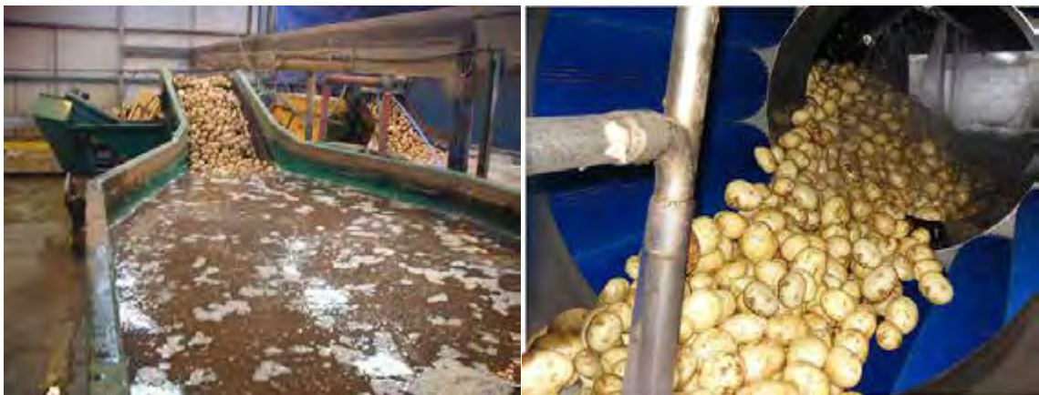
Рисунок 9.24. Ліворуч – місткість для попереднього замочування бульб. Праворуч – мийна та полірувальна машина барабанного типу
