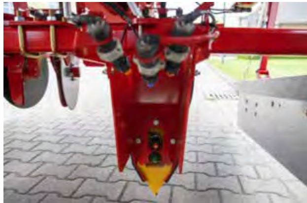
Рисунок 7.25. Розділені відсіки для одночасне внесення засобів захисту рослин і гранулятів сажалки GB 215
