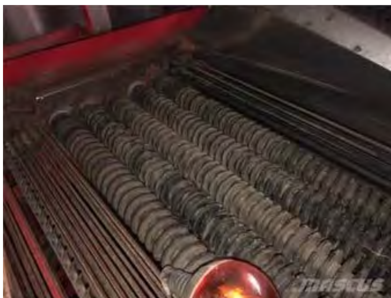
Рисунок 9.8. Сепарувальний орган вальцевого типу
