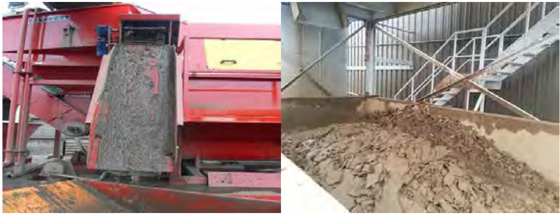
Рисунок 9.30. Ліворуч – Автоматичне видалення ґрунту після миття бульб. Праворуч – Збір сухого ґрунту, після циклу вижимки вологи
