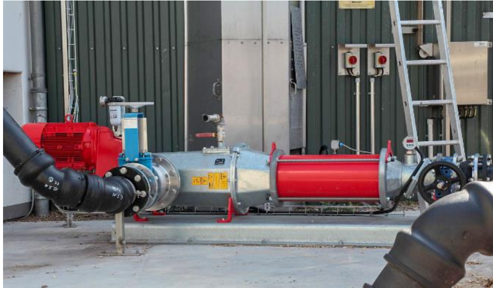
Рис. 1.7. Ексцентрично-шнековий насос Vogelsang CC-серії на біогазовому виробництві
