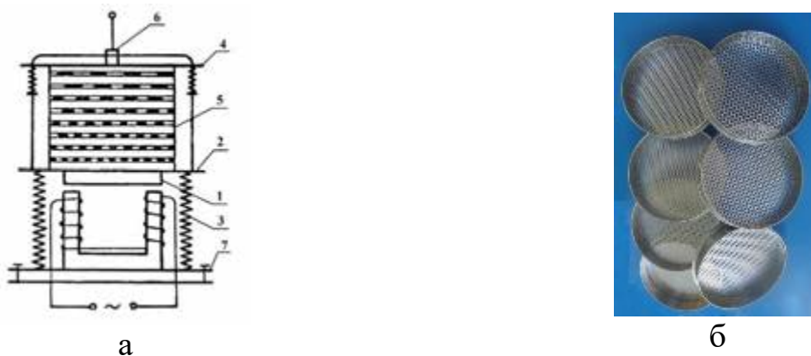
Рис. 2. Вібраційно-решітний класифікатор РКФ-1: а – функціональна схема; б – набір решіт.
