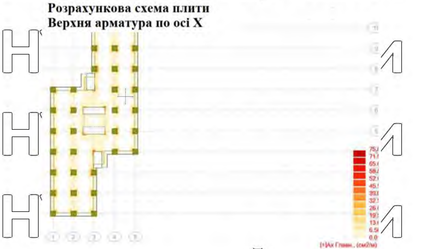
Рис. 3.3. Ізополя напружень по M_y
