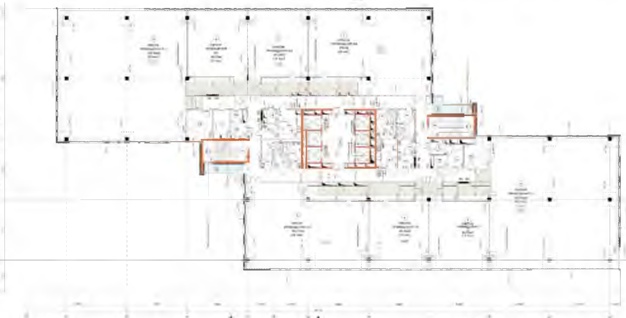
Рис. 2.2. Рамно-зв'язкова конструктивна схема
