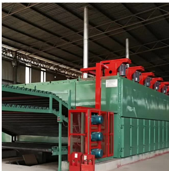
Рис. 1.13. Роликова сушарка шпону VTS-4-4200
