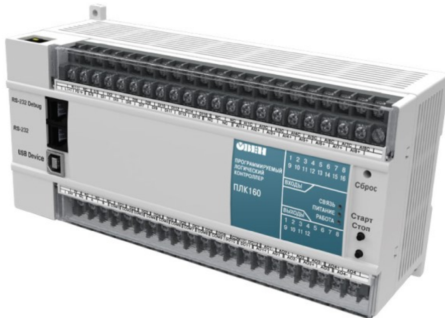
Рис. 3.1. Програмований логічний контролер ОВЕН ПЛК160
