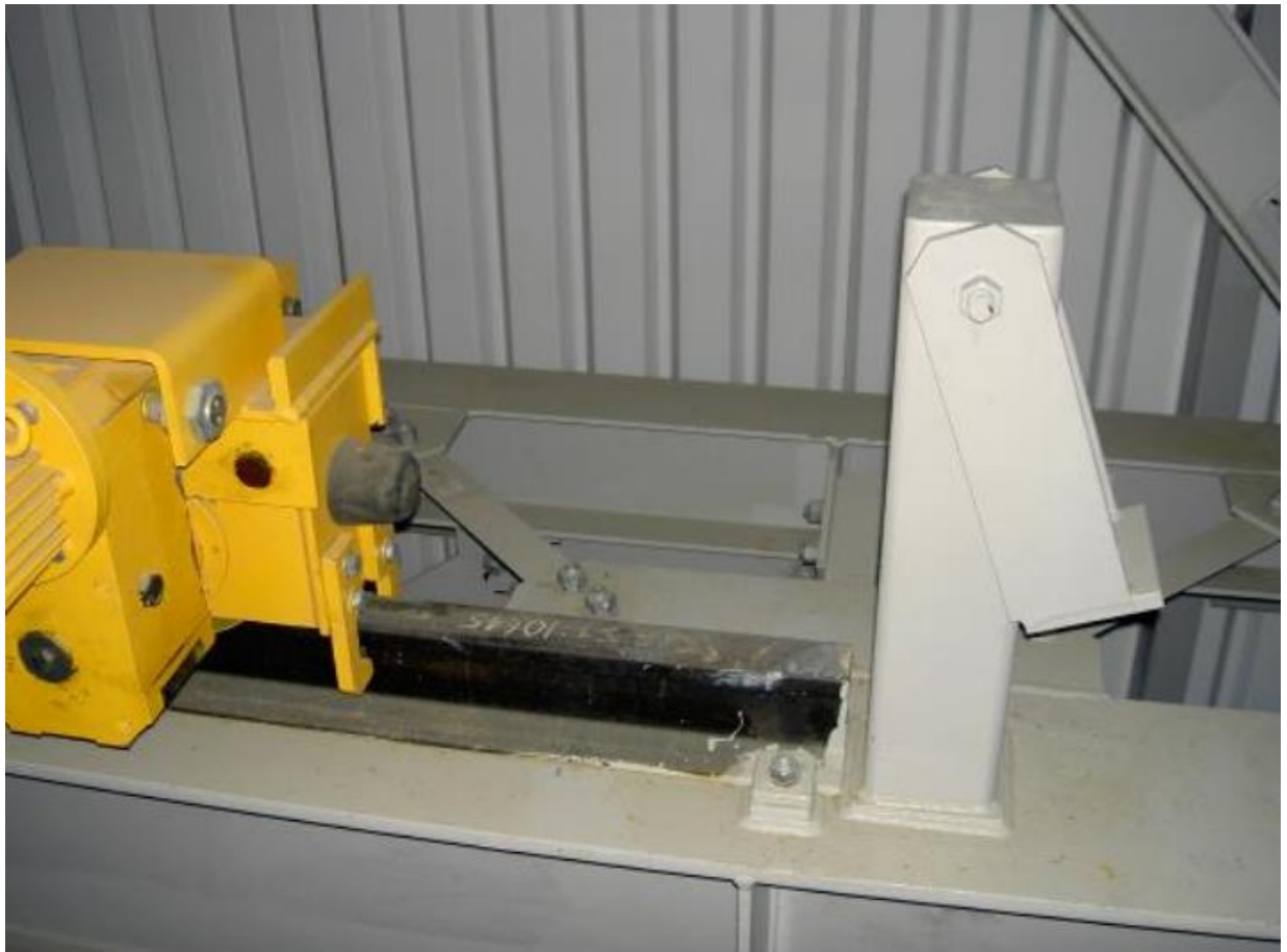
Рис. 8 Приклад конструкції «легкого» крана, оснащеного краноутримуючим пристроєм у поздовжньому та поперечному напрямках.
