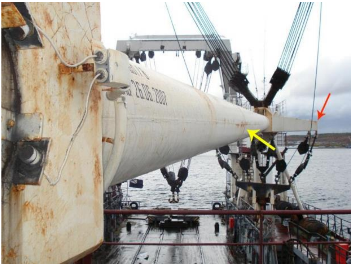
Рис. 9 Приклад наявності локальних залишкових деформацій кантилевера (показано жовтою стрілкою)
