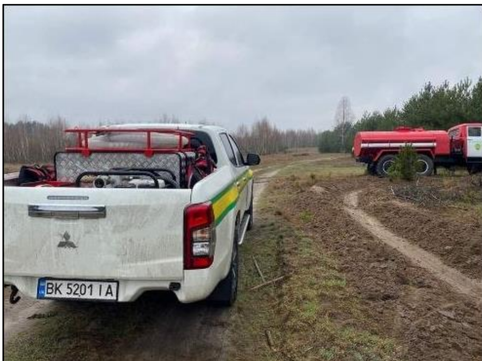
Рис. 4.12. Пожежний модуль швидкого реагування на лісові пожежі
