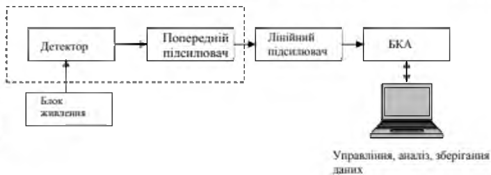
Рисунок 2.7 – Блок-схема стандартного гамма-спектрометра [54]
