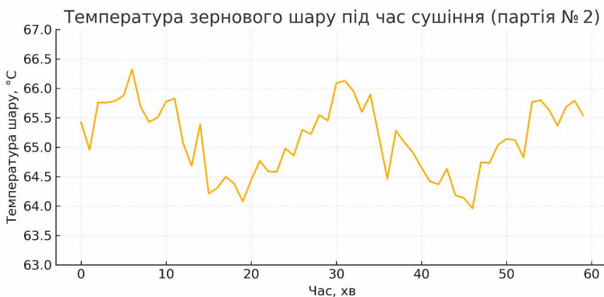
Рисунок 3.4 — Профіль температури під час сушіння
