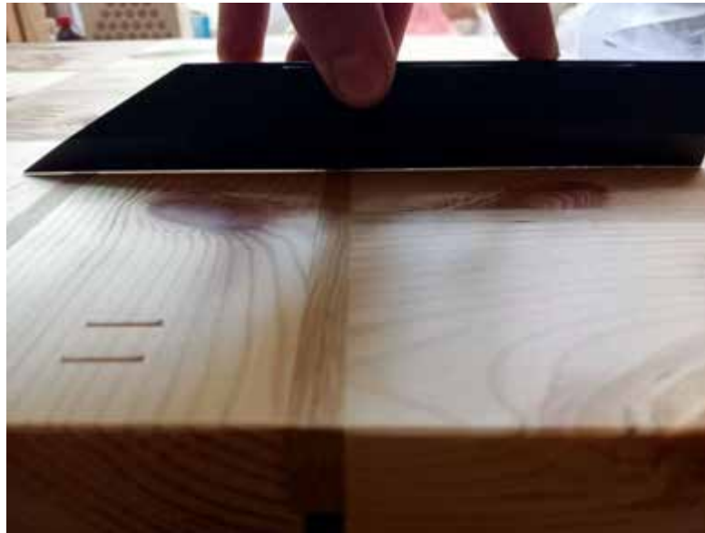
Рис. 4.7. Наочний огляд деформації зразків за допомогою лекальної лінійки, після періоду кондиціонування 30 діб
