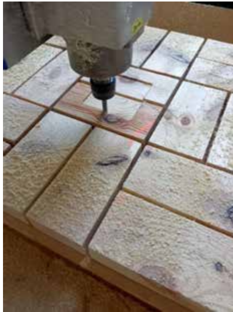
Рис. 4.3. Вирівнювання площини деталей
