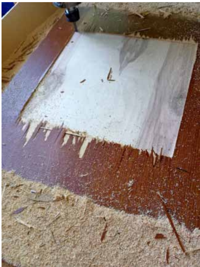
Рис. 4.2. Процес створення бази на основі із столярної плити
