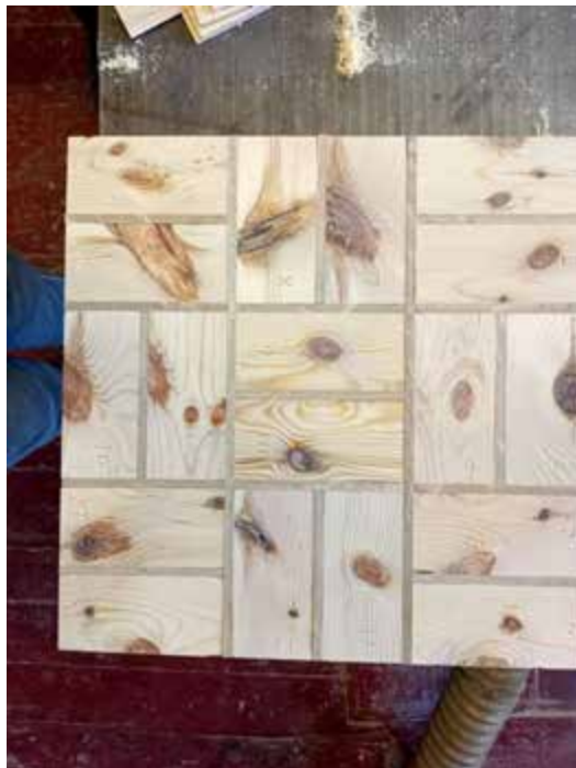
Рис 4.1. Готовий зразок для випробування формостійкості низькотоварної деревини
