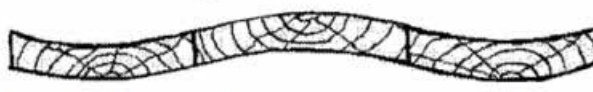
Рис. 2.15. Клеєний щит з широких ділянок тангенціального випилювання із розміщенням в перемінному напрямку річних шарів [41]
