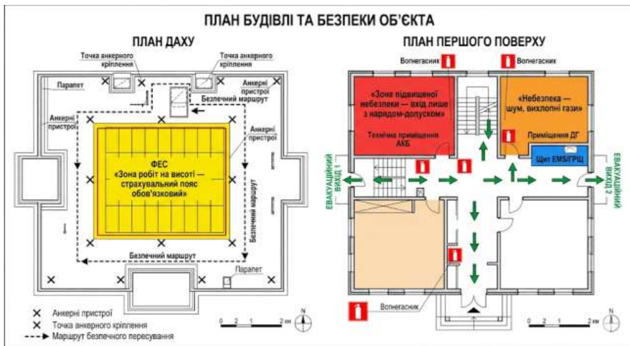
Рис. 4.4. Схема організації безпечного обслуговування гібридної системи електропостачання
