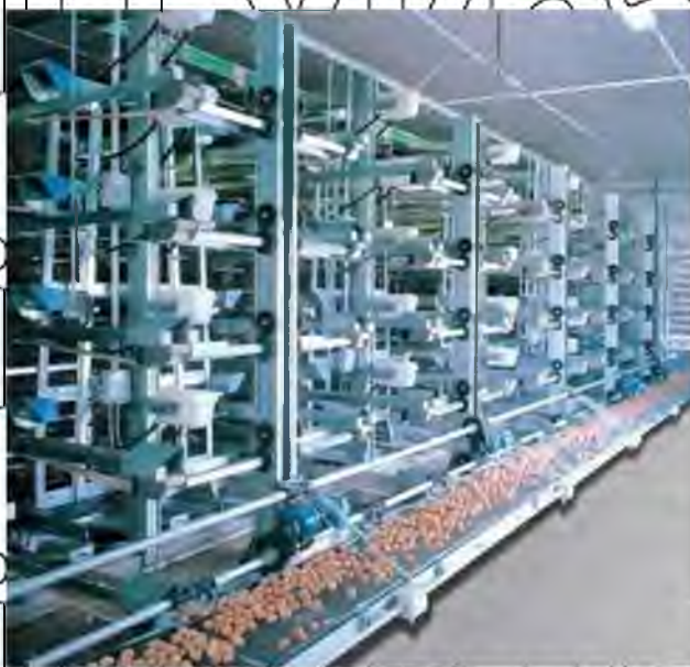
Рис. 5.5 Ліфтова система збирання яєць «Анаконда»
