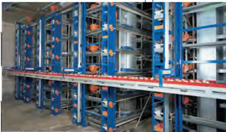
Рис. 5.6. Збирання та транспортування яєць з третього ярусу батарей
