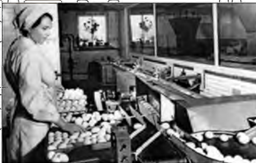
Рис. 5.1. Перші системи механізованого збирання та транспортування яєць
