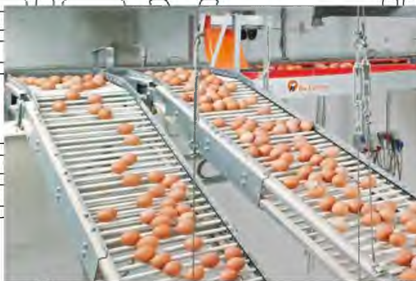
Рис. 5.7. Пруткові конвеєри для транспортування яєць
