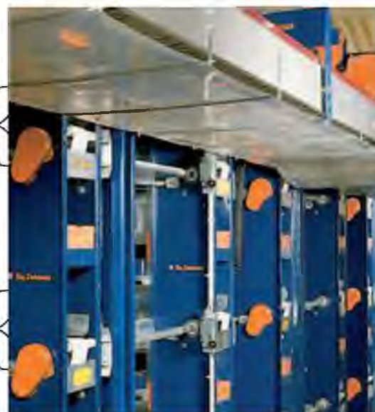
Рис. 5.8. Поперечний транспортер у стані «спокою»
