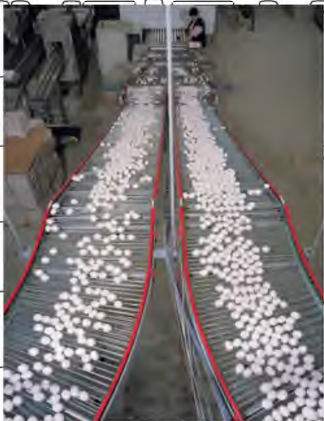
Рис. 5.18. Доставка яєць із пташників до сортувальних та пакувальних машин яйцесховища
