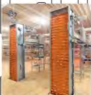
Рис. 5.13. Елеватор ЕС у багатопверховому пташнику
