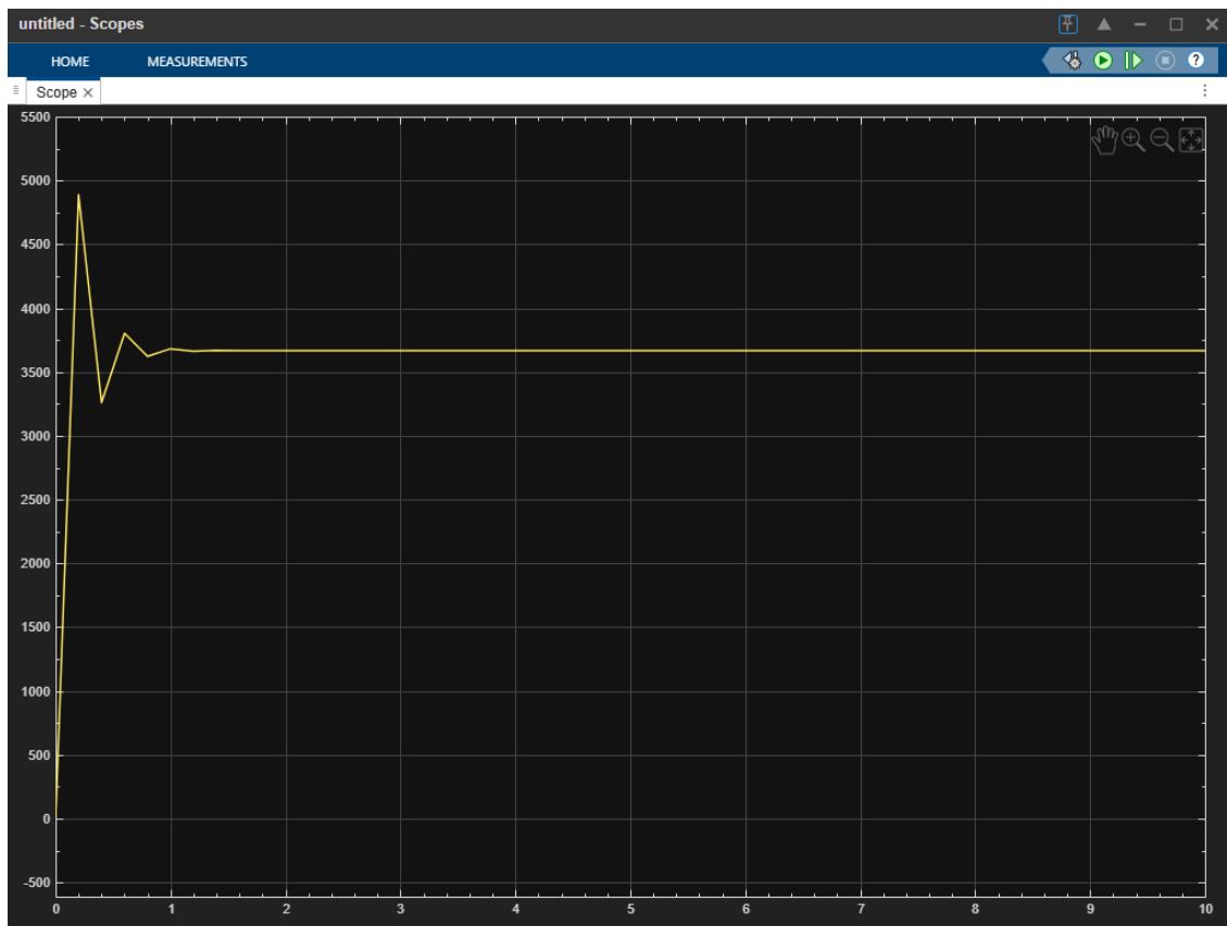
Рисунок 2.4 – Результати моделювання перехідного процесу швидкості приводу при максимальній інтенсивності опадів
