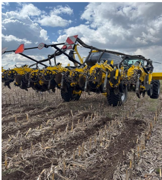
Рис. 2.3. Посів з одночасним внесенням добрив.
