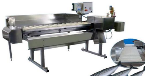
Рис 3.2 Розборозбиральна машина конвеєрного типу
