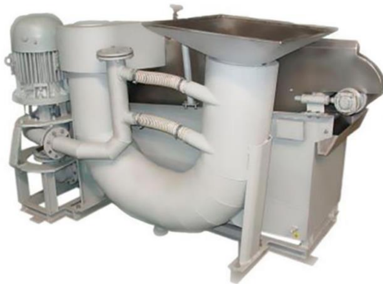
Рис. 3..3 Машина для миття риби в турбулізованому потоці води
