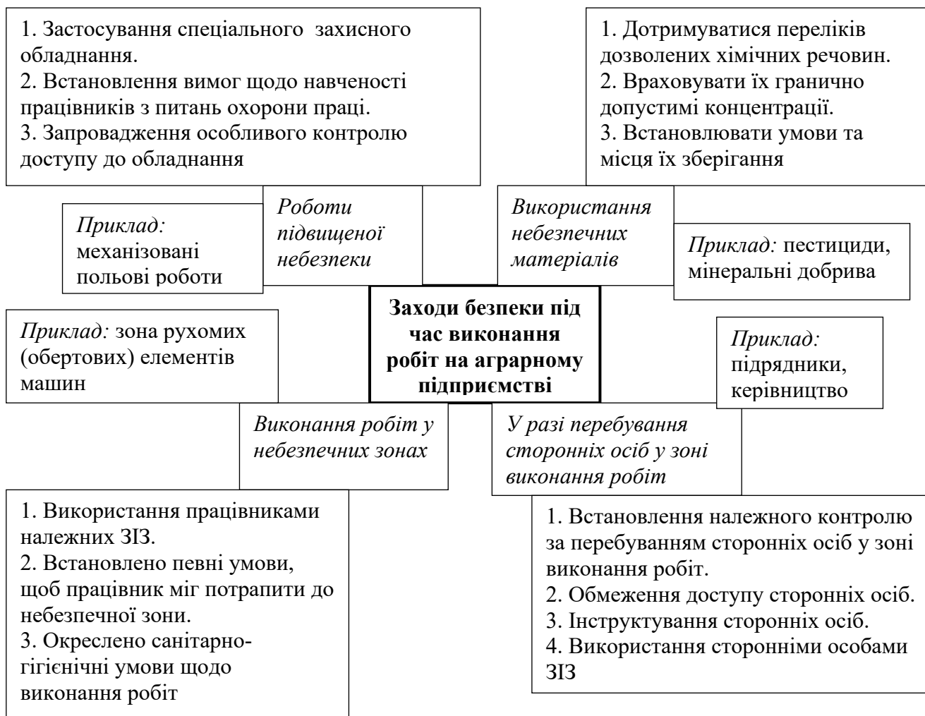
Рис. 4.7. Основні заходи безпеки праці у разі виконання робіт на малому сільськогосподарському підприємстві
