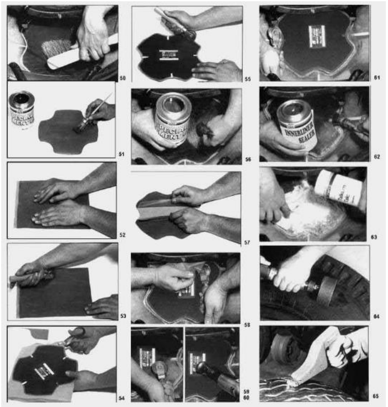
Рисунок 3.5 Технологія ремонту діагональних шин
