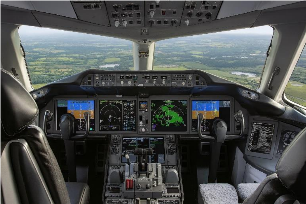
Рис. 1.4 Кабіна пілотів із великими дисплеями (glass cockpit).
