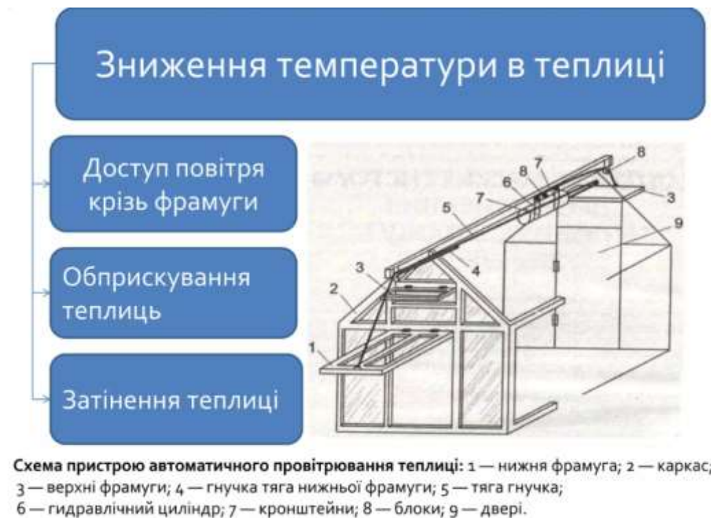
Рис.1.3. Схема пристосування автоматичного провітрювання теплиці
