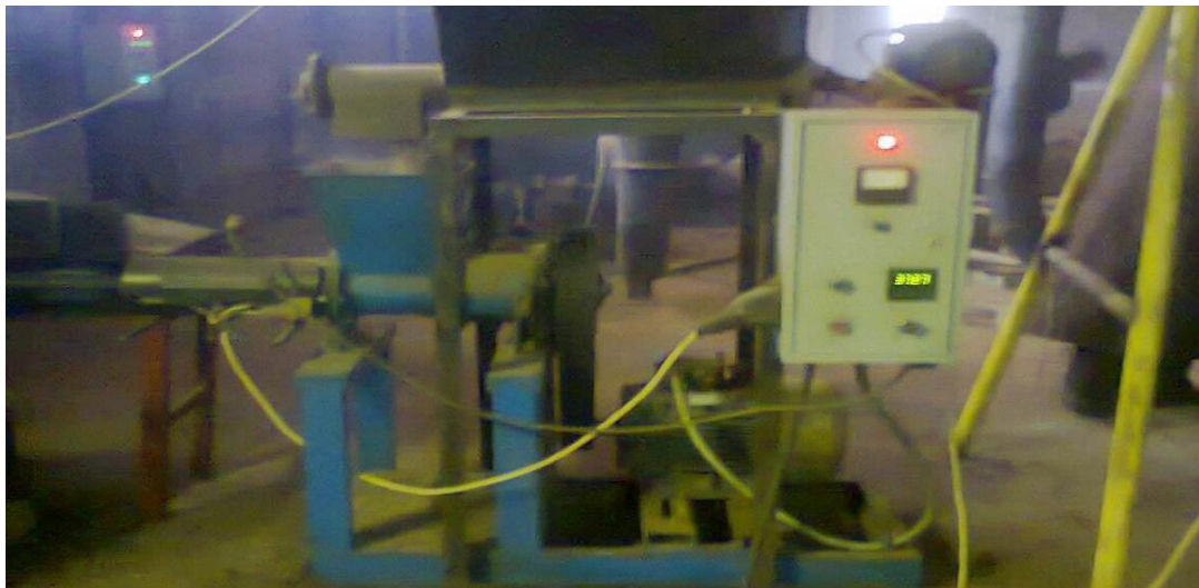
Рисунок 1.6. Загальний вигляд прес-брикетувальника ПШ-250.
