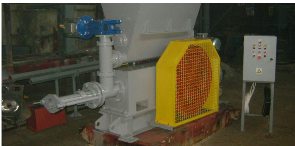
Рисунок 1.7. Загальний вигляд ударного преса РВ-500.
