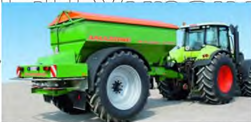
Рисунок 1.9 – Широкозахватний причіпний розкидач AMAZONE ZG-B Ultra Hydro /74/
