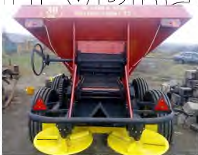
Рисунок 1.8 – Робочі органи розкидача мінеральних добрив
