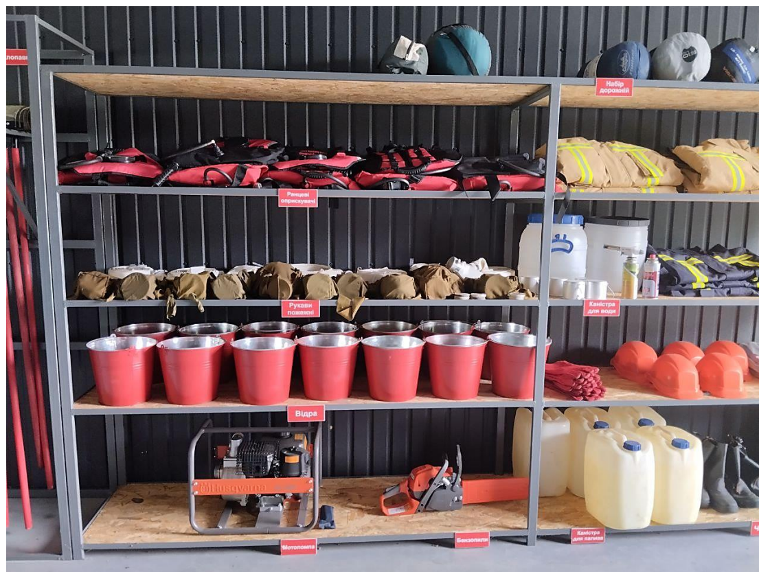
Рис. 4.12. Засоби пожежогасіння та індивідуального захисту, розміщені на станції
