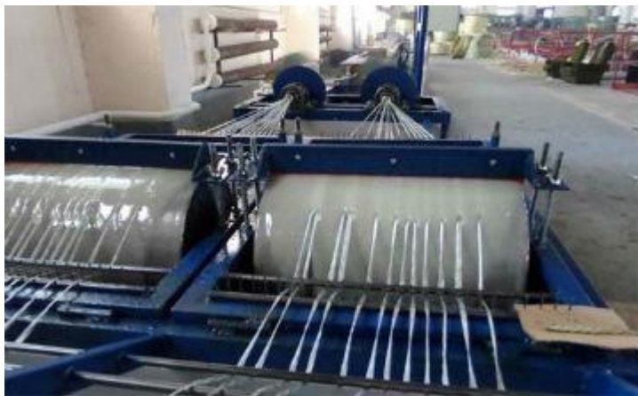
Рисунок 7.3. Змотування просоченого смолами ровінгу в пучок верстаком.
