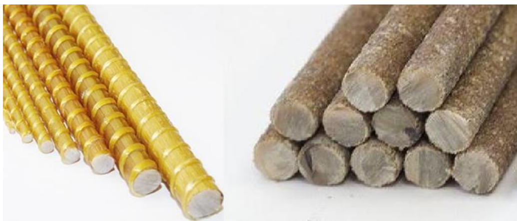
Рисунок 7.4. Метод підсилення зчеплення з композитною арматурою: а) формування ребер з ровінгу; б) нанесення покриття із піску
