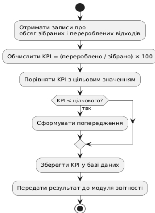
Рис. 13 Блок-схема алгоритму розрахунку КРІ
