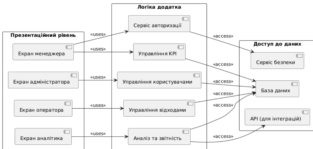
Рис. 8 Діаграма пакетів системи контролю та переробки відходів
