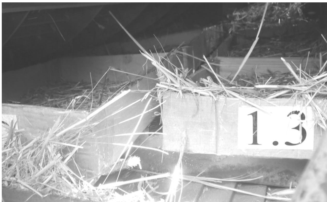
Рис. 3.13. Встановлення лотків під підбарабанням для відбору проб
