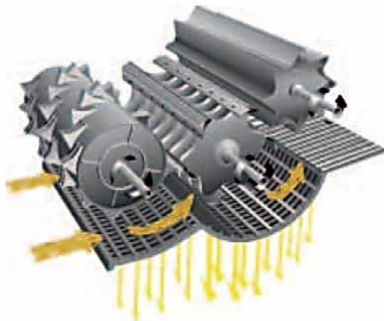
Рис. 1.2. Молотильно-сепаруючий пристрій зернозбирального комбайна MEGA фірми CLAAS
