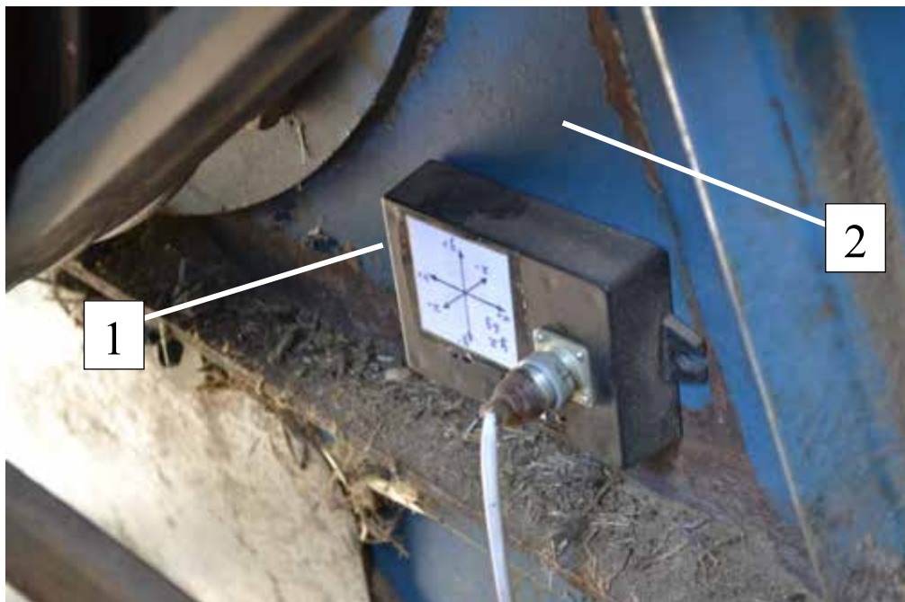
Рис. 3.6. Встановлення датчика прискорення: 1 – датчик прискорення; 2 – боковина зернозбирального комбайна.
