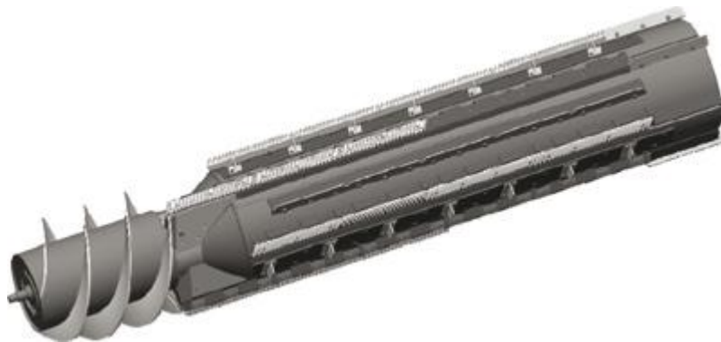
Рис. 1.18. Ротор зернозбирального комбайну Challenger 660/680
