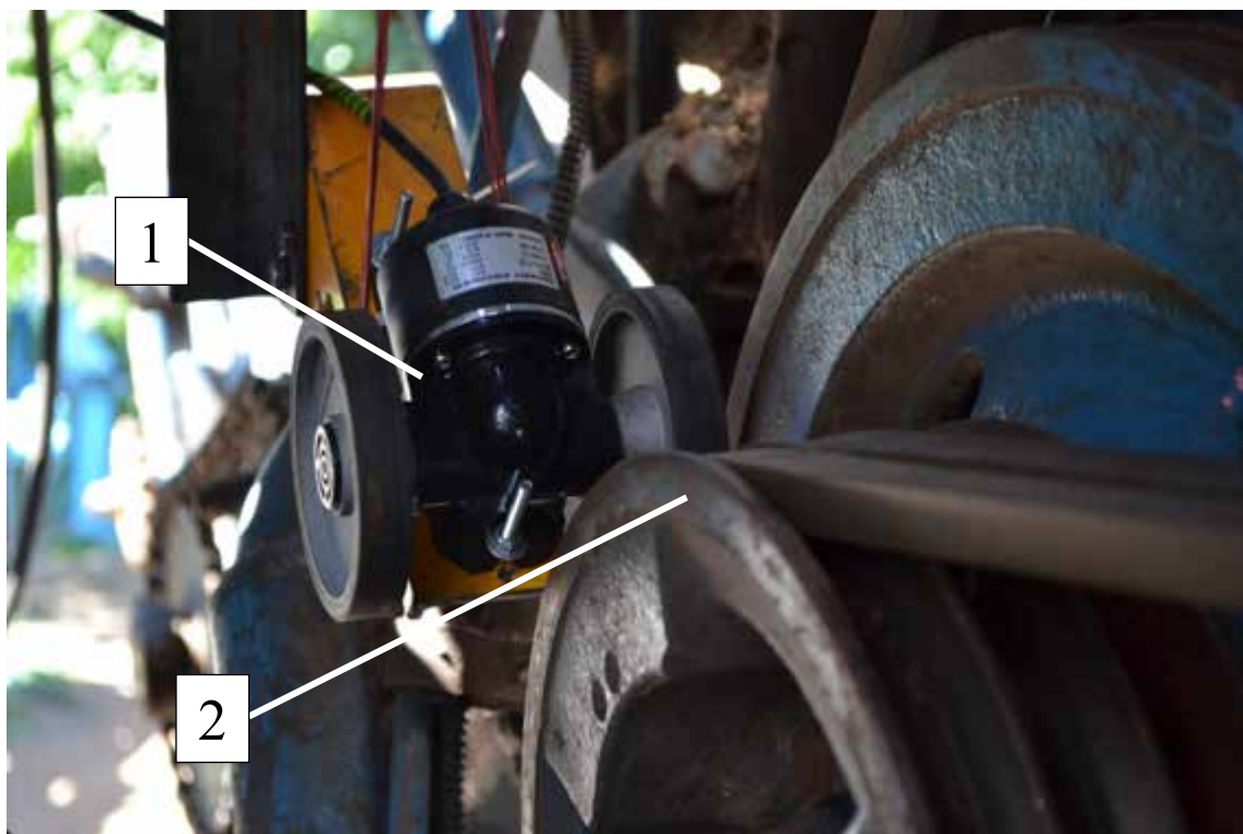
Рис. 3.4. Встановлення лінійного енкодера ENC Autonics на зернозбиральному комбайні: 1 – лінійного енкодера ENC Autonics; 2 – шків пасової передачі, що розміщений на валу ДВЗ
