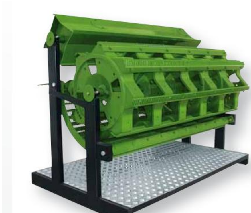
Рис. 1.5. Молотильний барабан комбайна серії 1470/1570
