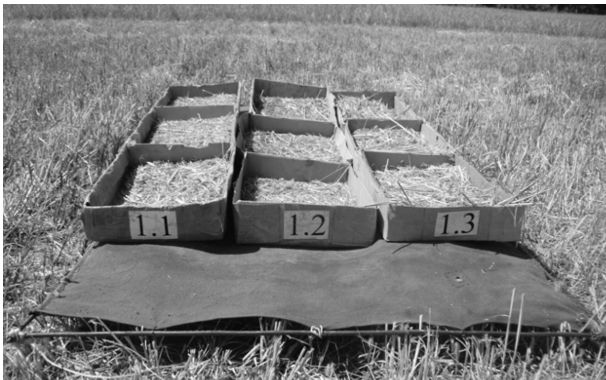
Рис. 3.2. Лотки для проведення експериментальних досліджень з визначення просівної здатності підбарабання
