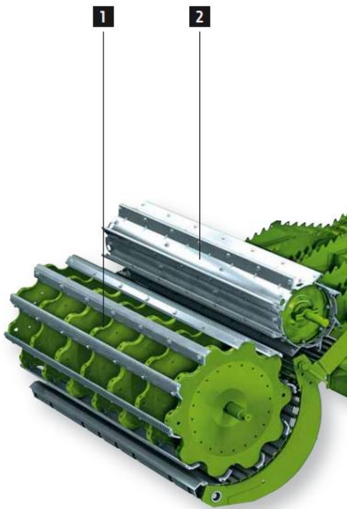
Рис. 1.6. Молотильно-сепаруючий пристрій зернозбирального комбайна серії W (1 – молотильний барабан; 2 – відбійний бітер)
