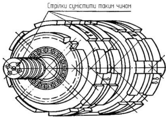
Рисунок 1.6 – Порядок установки гідропідтискних муфт коробки передач трактора ХТЗ-17221
